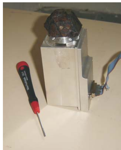
Figura 1 - Fragmento de meteorito em análise no MIMOS II, cujas dimensões são (9x5x5)cm.
