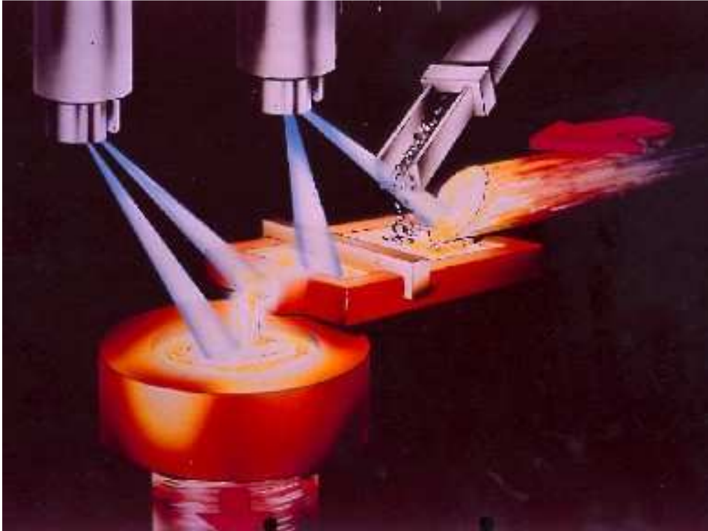
Figura 4: Ilustração de 1ª fusão com cold-hearth [8] .
