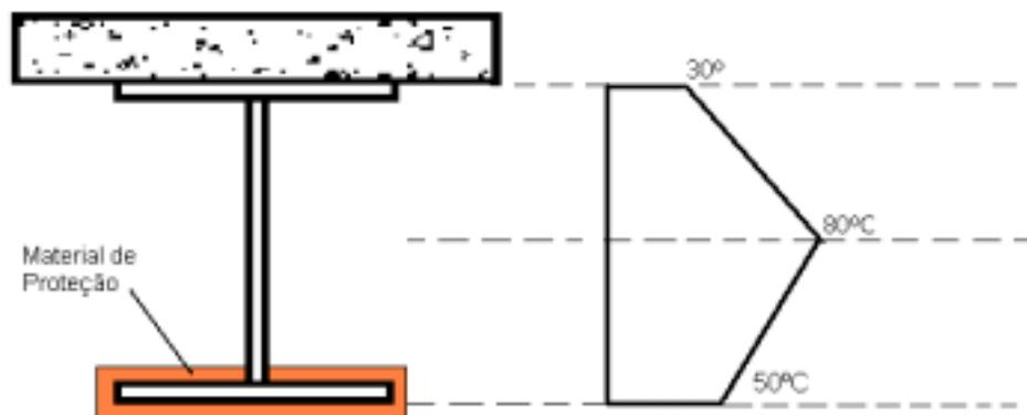
Figura 3.5 - Distribuição da temperatura na viga protegida.
