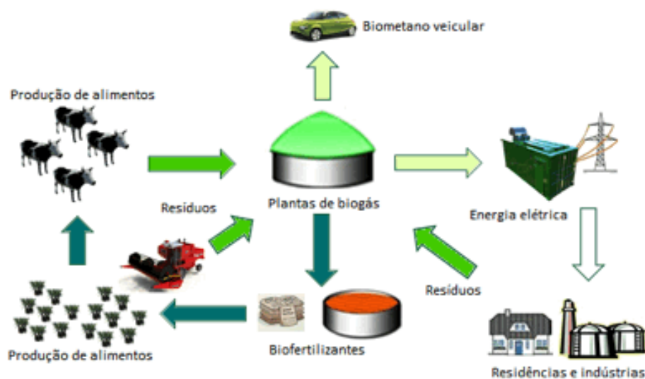
Figura 7: Ciclo de Produção de Biogás. Fonte: Souza et al, 2014.
