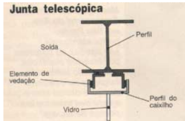
Figura 95 - Esquema de junta telescópica para fechamentos com fachada de vidro – COSTA 21
