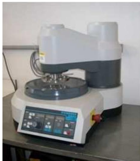
Figura 4.2- Politriz automática utilizada no polimento das amostras de aço AISI 439.
