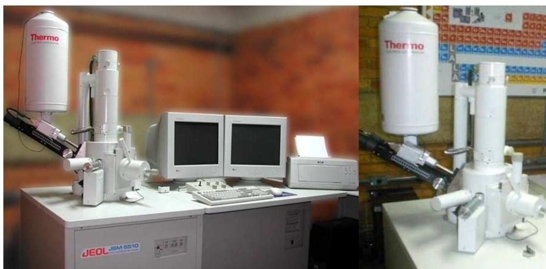
Figura 4.4-Microscópio Eletrônico de Varredura-MEV e EDS-DEGEO-UFOP.
