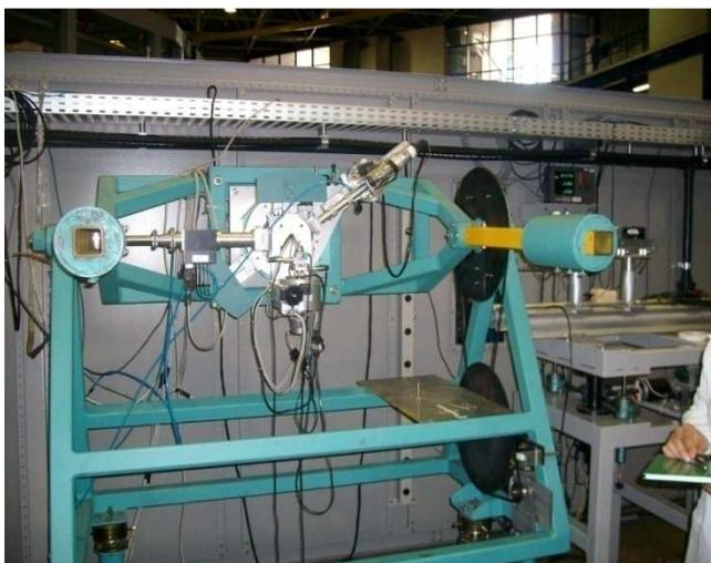
Figura 4.5- Difratorômetro de 3 círculos da marca Huber da linha XRD1 do LNLS.
