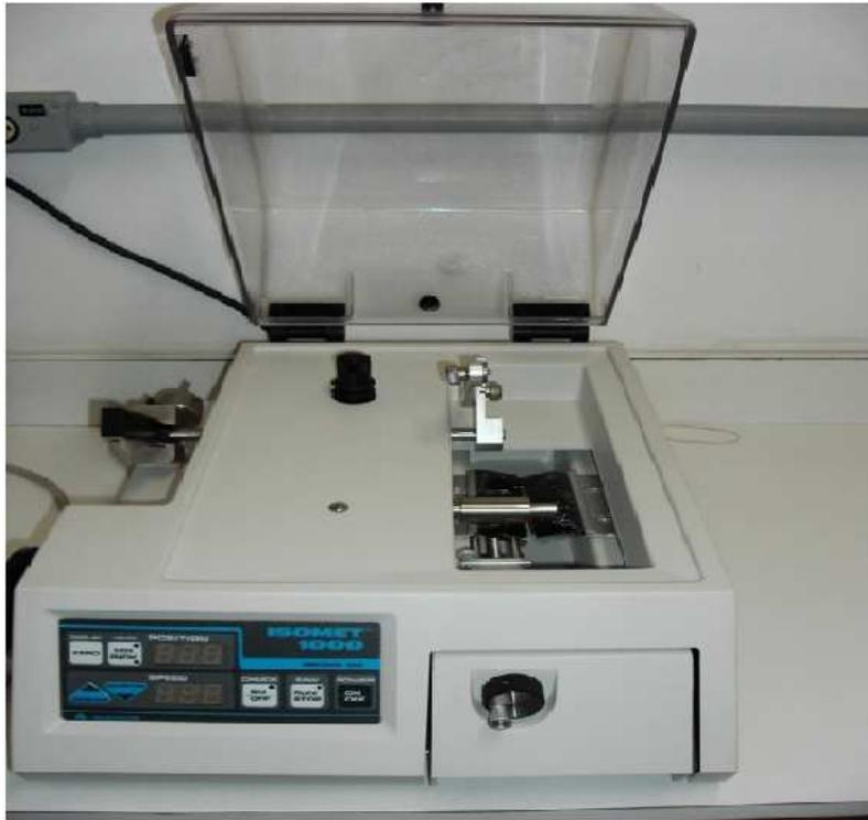
Figura 4.1-Máquina de corte utilizada na preparação das amostras de AISI 439.
