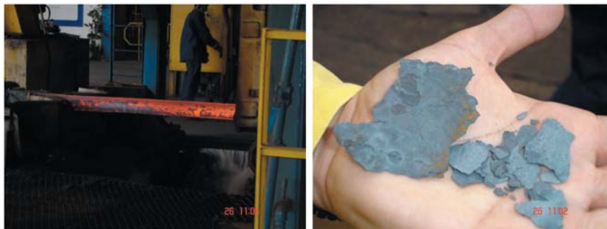
Figura 1 - Carepas na superfície do tarugo de aço (esquerda) e carepas eliminadas pelo processo (direita).
