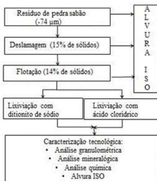
Figura 1 – Fluxograma de purificação e caracterização da amostra de resíduo de pedra sabão.
