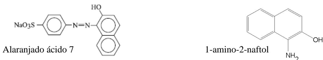
**Figura 2.6** - Estrutura química do azo corante alaranjado ácido 7 e do composto 1-amino-2-naftol.
