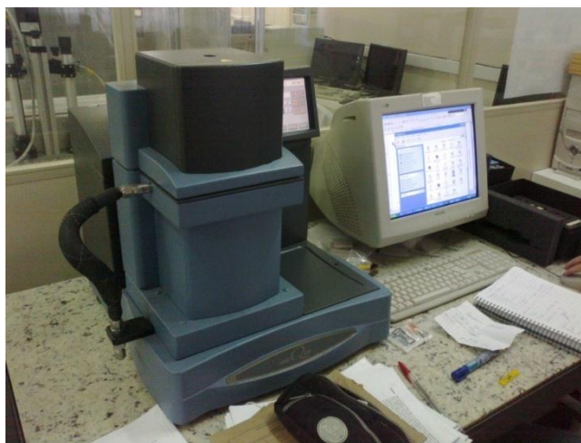
Figura 4.3: Equipamento de DMA da UFSCar – Sorocaba utilizado para as análises de comportamento mecânico das fibras.
