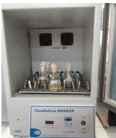
Figura 4.5: Ensaio em Incubadora tipo shaker - Solab Scientifica.
