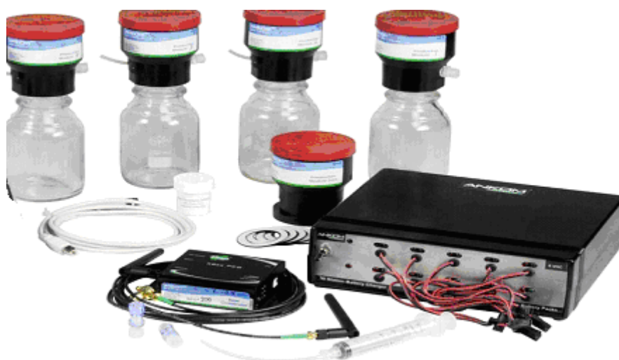
Figura 4.2: Respirômetro automatizado ANKOM RF GÁS PRODUCTION SYSTEM.
