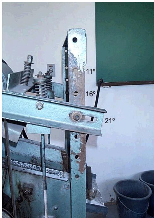
Figura 4. 4 - furos de regulagem (os números são a atribuição dos ângulos aos respectivos furos) de inclinação da peneira
