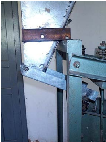
Figura 4. 2 - silo e calha de alimentação solidários à peneira inclinada.
