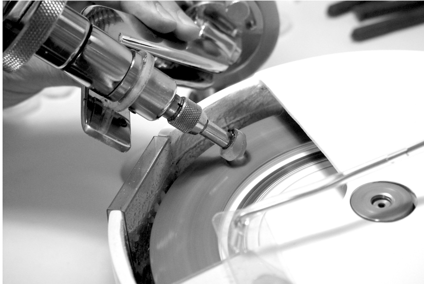
Figura 2.26: Gema em contato com o disco de corte, em um ângulo de aproximadamente 40° (LAPIDART, 2003).
