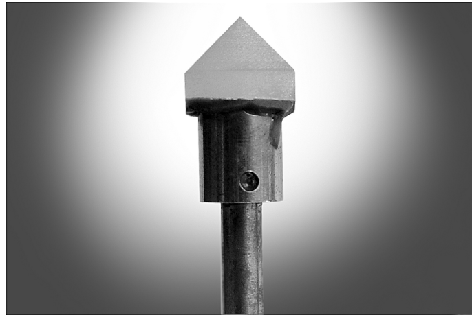
Figura 2.24: Gema formada fixa no dop com lacre (LAPIDART, 2003).
