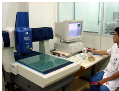
Figura 5.11 – Máquina de medição tridimensional do Laboratório de Metrologia, SENAI-EL.
