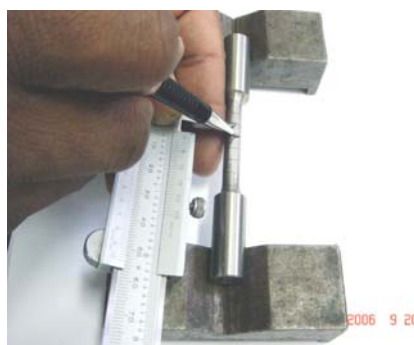
Figura 5.16 – Marcação da base de medida do corpo-de-prova de tração empregando o paquímetro.
