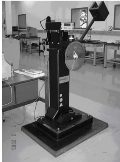
Figura 5.3 – Máquina pendular de impacto Charpy, DI-300, 406,7J, instalada no Laboratório A.
