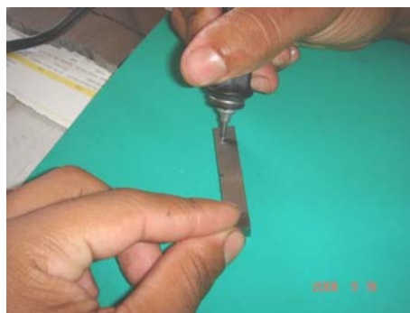
Figura 5.13 – Identificação do corpo-de-prova Charpy com marcador eletromecânico tipo punção.
