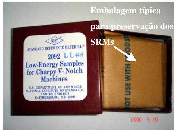
Figura 5.25 – Embalagem para manutenção do aspecto das superfícies dos materiais de referência durante o transporte e armazenamento.
