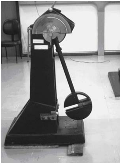
Figura 4.11 – Máquina pendular de impacto Charpy 300J (Laboratório A).
