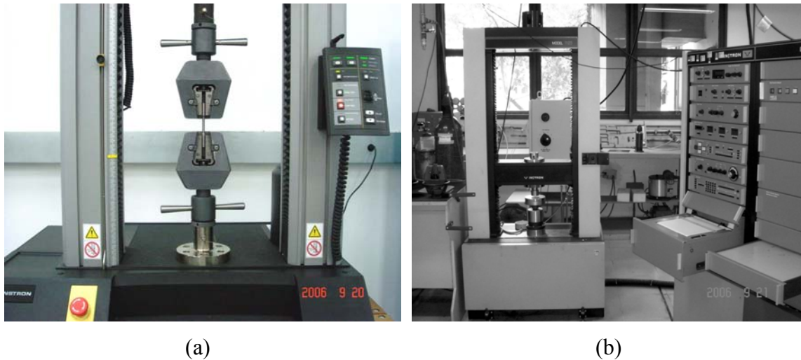
Figura 5.18 – Máquinas universais de ensaios utilizadas nos ensaios de tração; (a) MUE 50kN do Laboratório A e, (b) MUE 100kN do Laboratório do SDT/CETEC.
