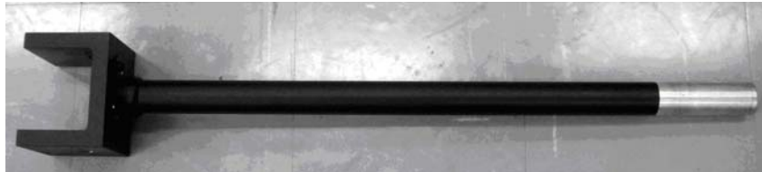
Figura 5.1 – Pêndulo leve da máquina de impacto Charpy, SATEC DI-300 do Laboratório A.
