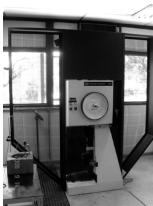
Figura 5.22 – Máquina pendular de impacto Charpy, 300J (Laboratório B).
