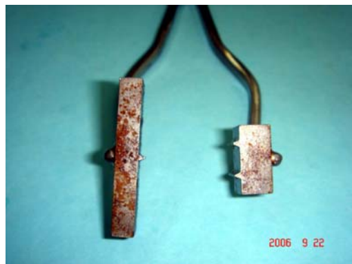
Figura 5.20 - Detalhe da pinça ASTM, que permite o auto centramento do corpo-de-prova Charpy nos dispositivos de apoio da máquina pendular.
