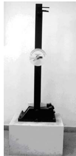
Figura 4.12 – Máquina pendular de impacto Charpy, 30J (Laboratório B).
