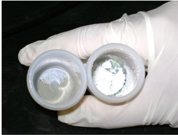
Figura 3.5: Amostras secas, em fase de preparação para análise por ICP-EOS.
