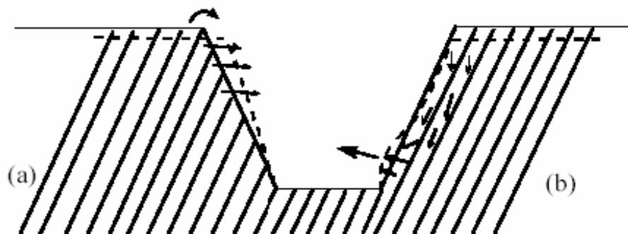
Figura 2.5 - Mecanismos não usuais de processos de instabilização de taludes em rochas xistosas (desenho esquemático). (a) Tombamento flexural e (b) Flambagem (Adhikary et al. 1996).
