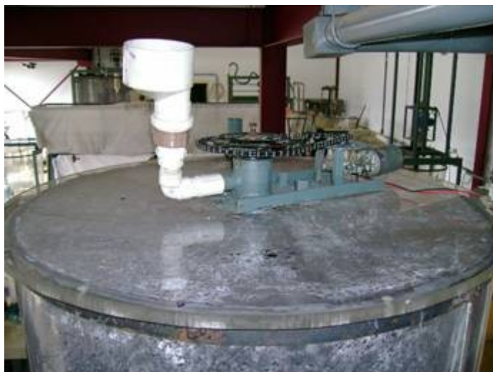
Figura 5.4 – Detalhes da montagem experimental, sistema de rotação e aspersão.
