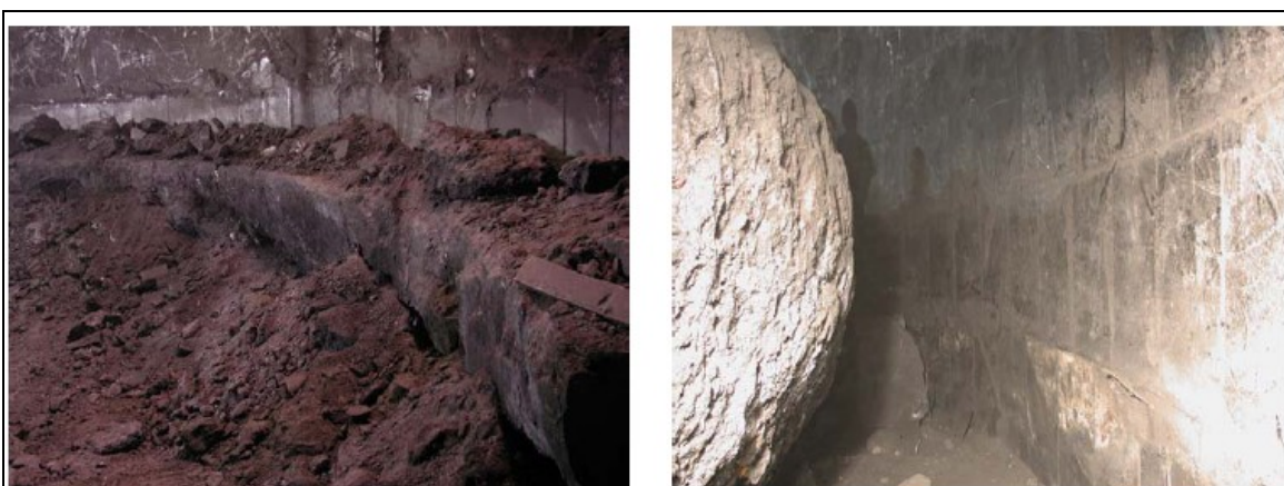
Figura 3.27 – Desgaste tipo pata de elefante no revestimento dos blocos de carbono encontrado no alto forno # 7 de ISPAT Inland's segundo Bobek e outros (2004).
