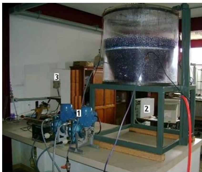
Figura 5.3 – Detalhes da montagem experimental, visão geral do conjunto: 1- bombas peristálticas de sucção pelos furos de gusa; 2- PC para leitura de dados de condutividade; 3- inversor de frequência para acionamento das peristálticas.
