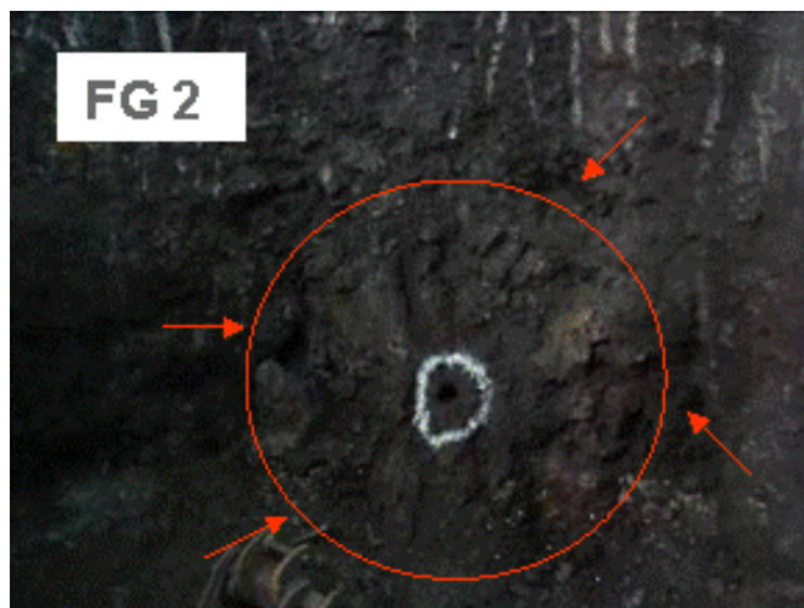
Figura 6.75 – Cogumelo do furo de gusa 2 com os locais de desgastes evidenciados em seu redor.
