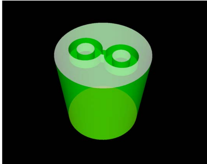
Figura 4.20 – Regiões com condição de contorno de parede.
