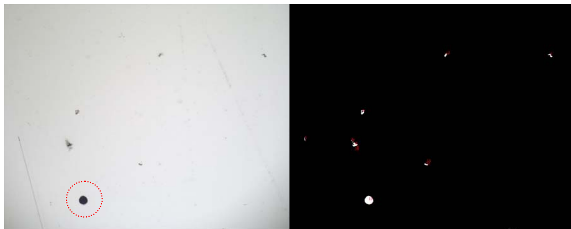
Figura 4. 11 – Modelo de identificação de inclusões nodulares.
