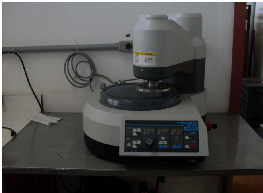
Figura 4.9 - Politriz semi-automática localizada no Laboratório de Difusão em Materiais do Departamento de Física (DEFIS) da UFOP
