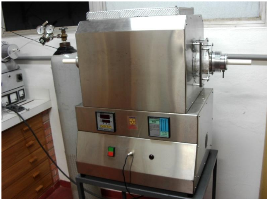
Figura 4.8 - Forno tubular com resistência de dissiliceto de molibdênio localizado no Laboratório de Difusão em Materiais do Departamento de Física (DEFIS) da UFOP
