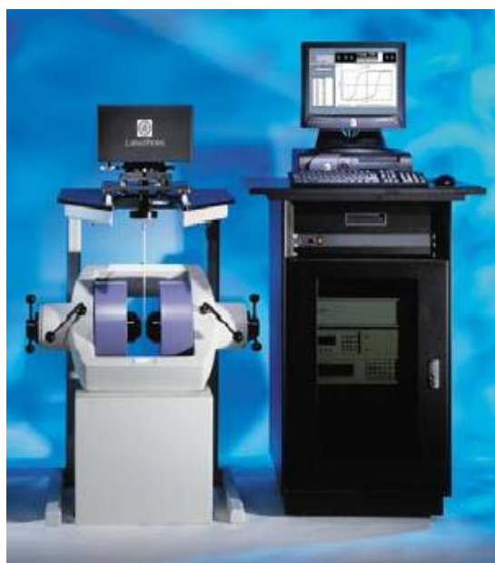
Figura 4.11 - Magnetômetro de amostra vibrante (MAV) da marca LakeShore modelo 7407 localizado no Laboratório de Materiais Cerâmicos do Departamento de Ciências (DCE) da UNIFEI
