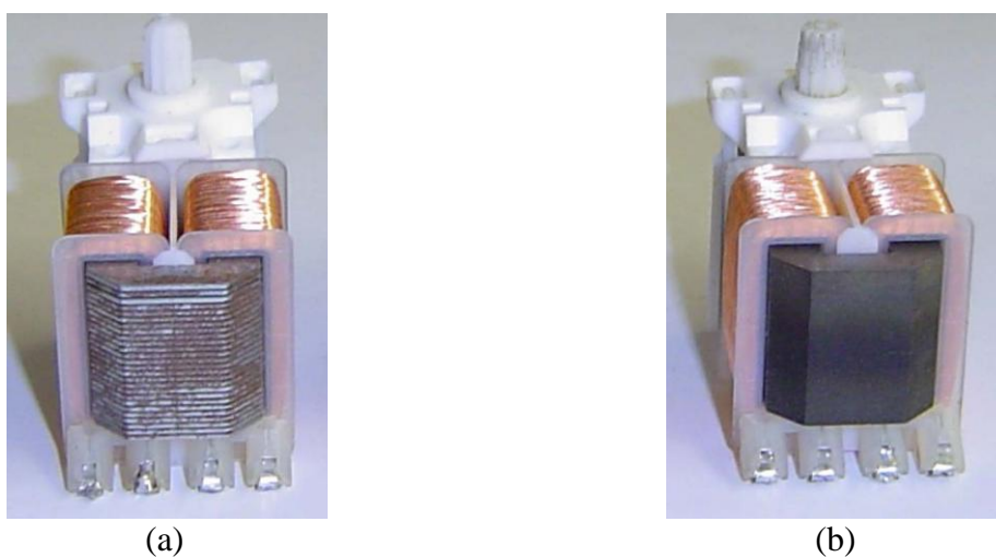
Figura 3.22 - Motor de corrente alternada com núcleo de (a) aço laminado e (b) compósito magnético macio[37]
