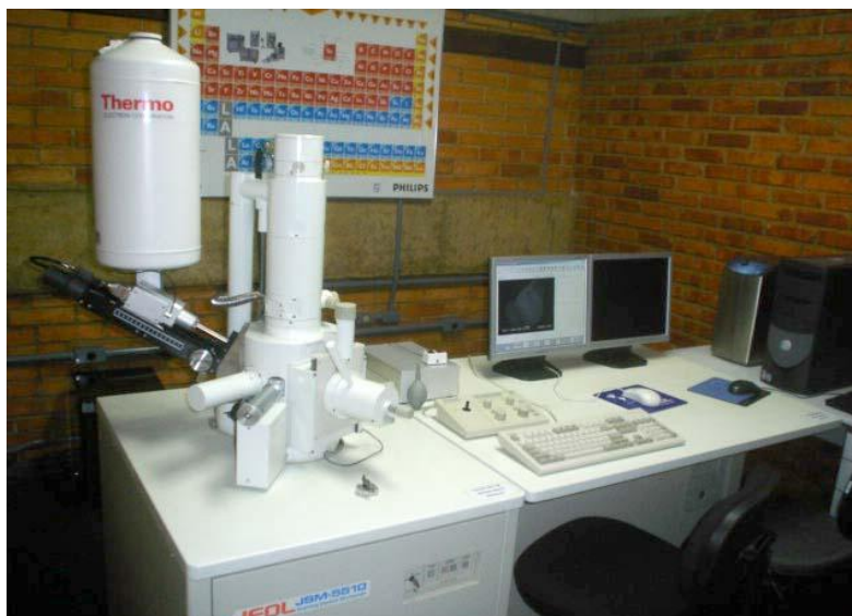
Figura 4.10 – Sistema MEV-EDS localizado no Departamento de Geologia (DEGEO) da UFOP
