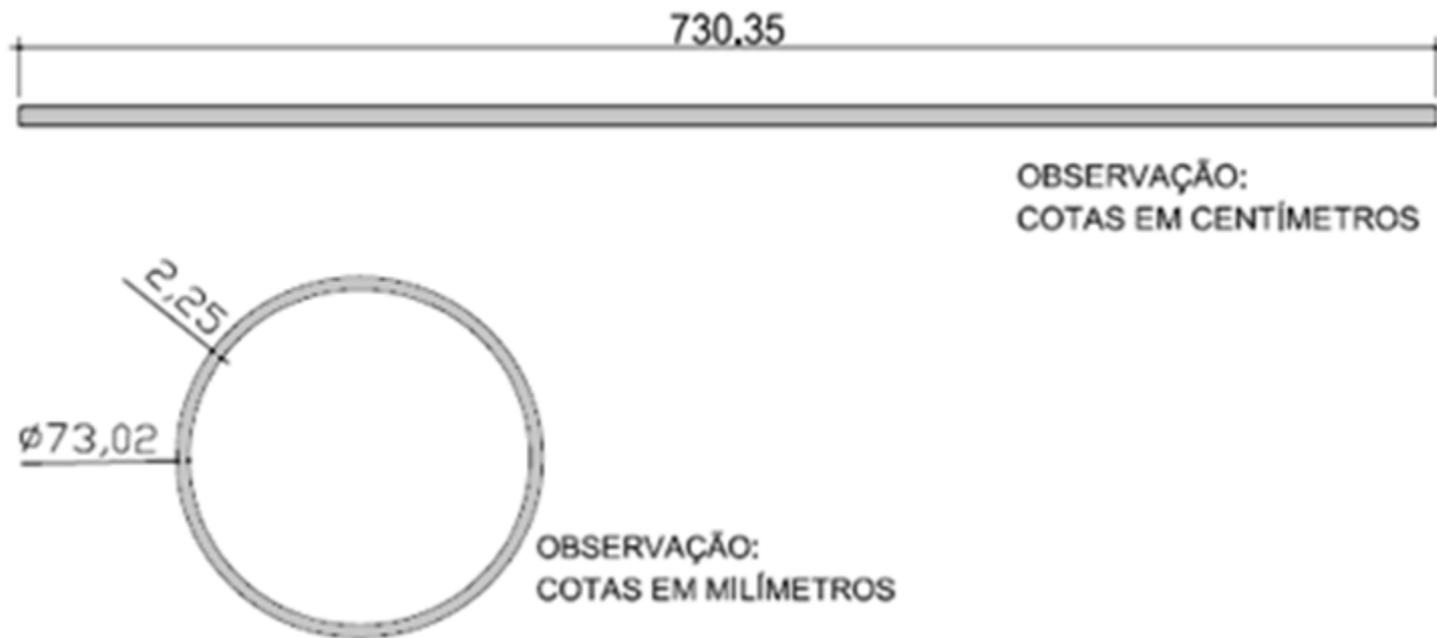
FIG. 26 - Desenho esquemático do tubo metálico com costura
