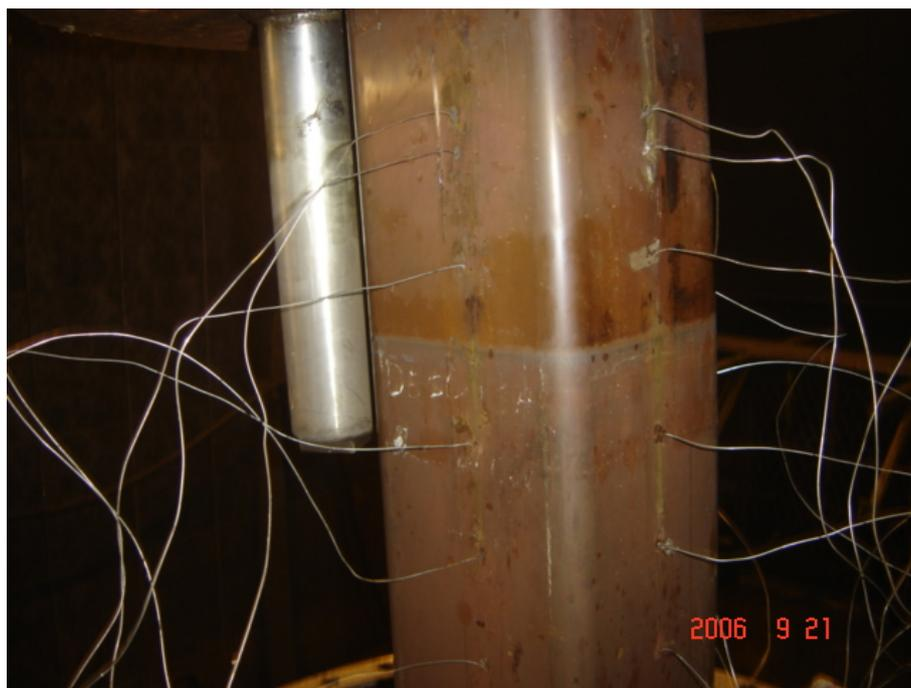
Figura 4.2 – Montagem dos termopares no tubo de cobre.
