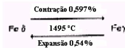
Figura 2.20- Desenho esquemático que retrata a mudança de fase e contração de volume.
