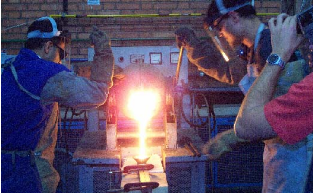
Figura 4.13 - Vazamento do material fundido no Viscosímetro Herty.
