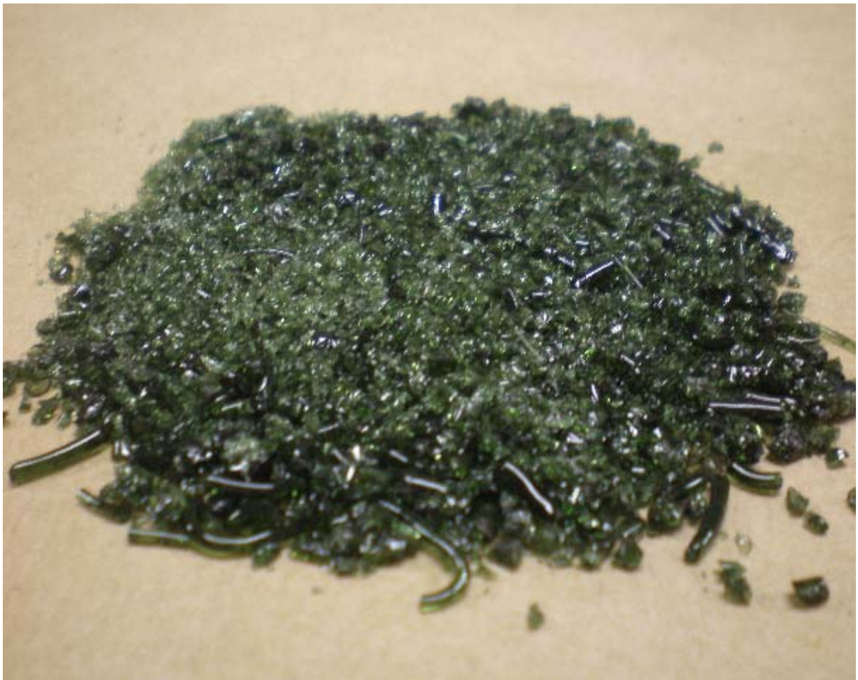
Figura 5.7 - Amostra do material formado através da mistura da escória de aciaria com aditivos, visando a produção de lã de rocha.
