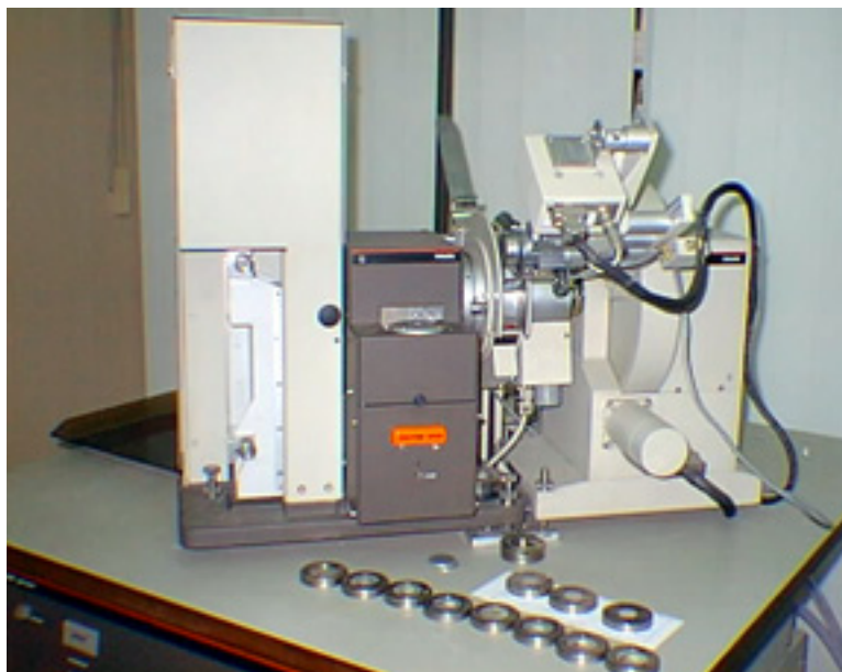
Figura 4.10 - Difratômetro de raios-X utilizado (PMI, 2008).
