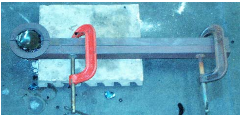
Figura 4.14 - Viscosímetro Herty após o resfriamento do material.
