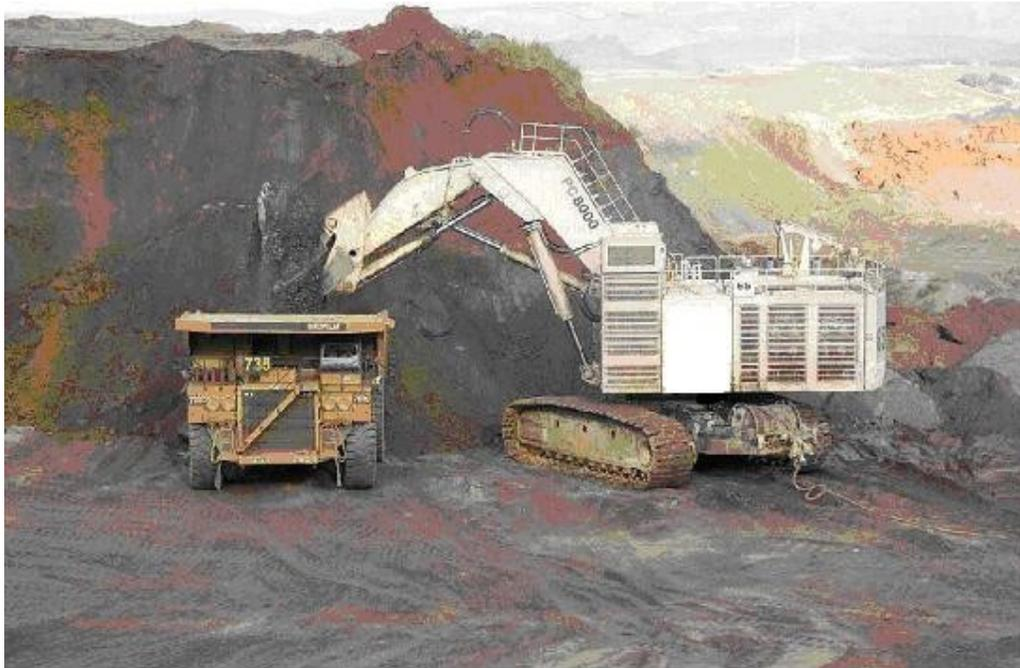
Figura 2.9 – Equipamentos de Transporte e de Carga
