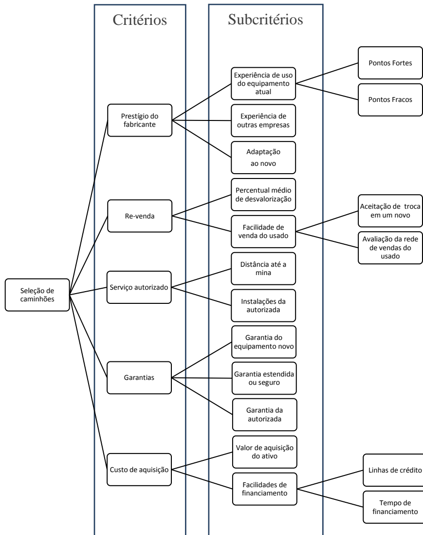
Figura 13: Estrutura hierárquica do problema de seleção de caminhões rodoviários adaptados para mineração
