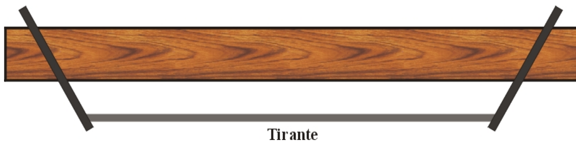
Figura 3. 10 – Reforço de viga com barras de aço e tirantes unindo-as.
