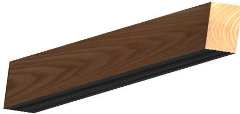
Figura 3. 13 – Reforço de viga com chapa presa na face inferior da viga de madeira com parafusos e adesivo de alta aderência.
