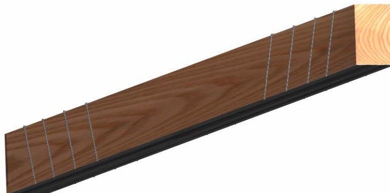
Figura 3. 8 – Reforço de viga com chapa presa na face inferior da viga de madeira com barras inclinadas.
