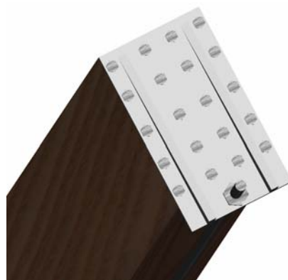
Figura 3. 14 – Reforço de viga de madeira com chapa de topo e tirantes, (a) vista longitudinal; (b) detalhe da chapa de topo
