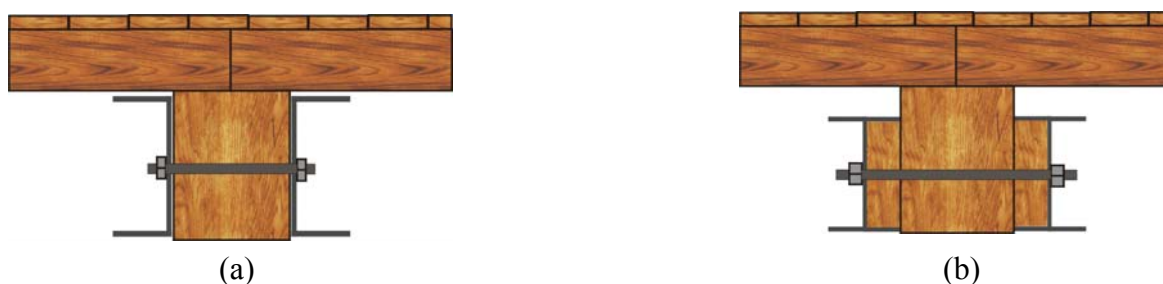
Figura 3. 7 – Perfis dobrado a frio, laminados ou soldados ligados a cada viga de madeira.
