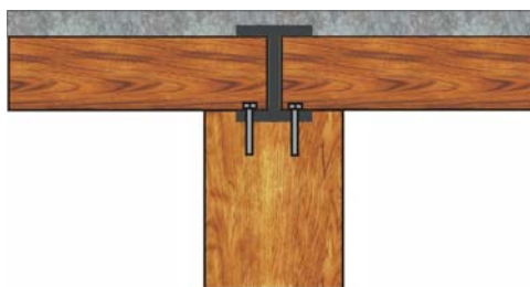
Figura 3. 9 – Reforço com perfil I na parte superior da viga de madeira
