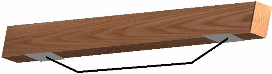
Figura 6. 14 – Reforço em viga de madeira com tirante em forma de U
