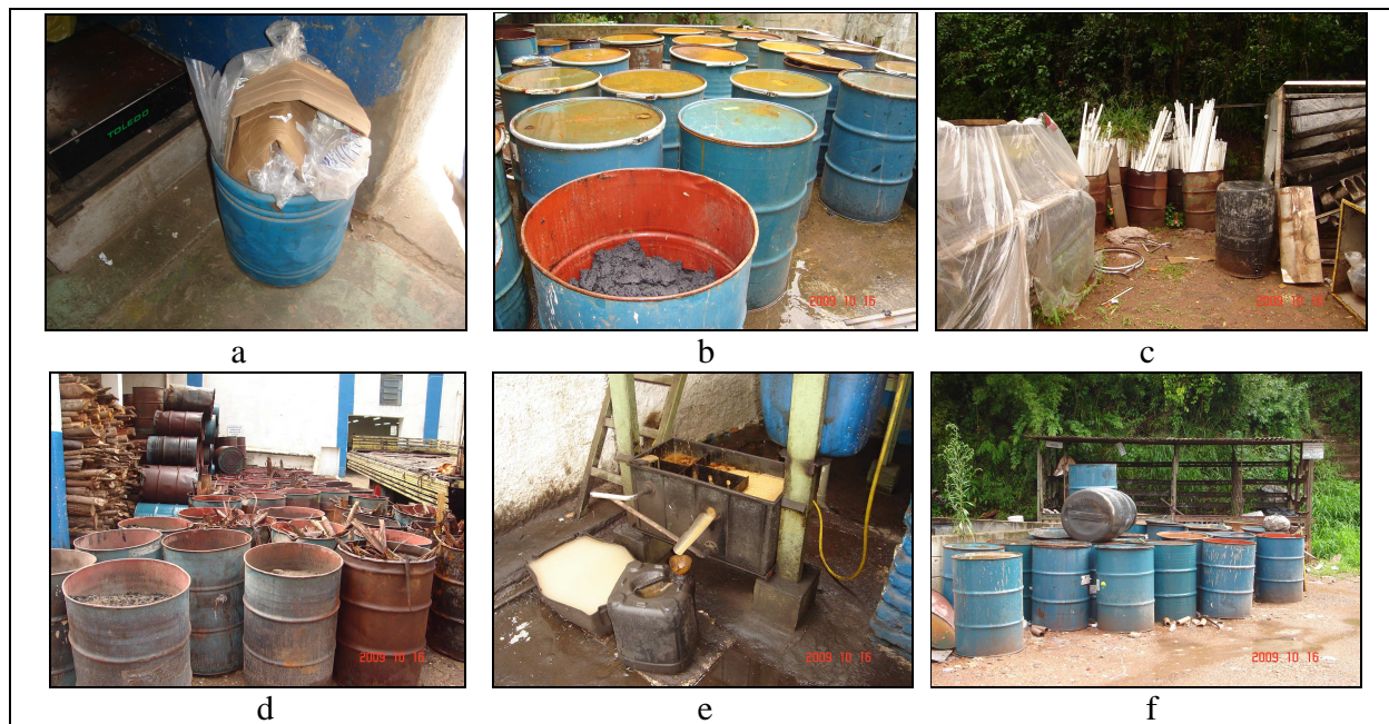
FIGURA 5.2 – Segregação e acondicionamento dos resíduos sólidos gerados na indústria L
