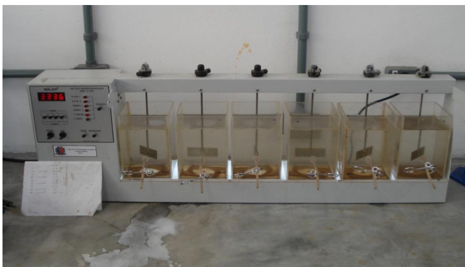
Figura 5.2 Ensaio ETA Funil utilizando as dosagens 15, 20, 25, 30, 35 e 40 mg/L de coagulante sulfato de alumínio, com turbidez 200uT.
