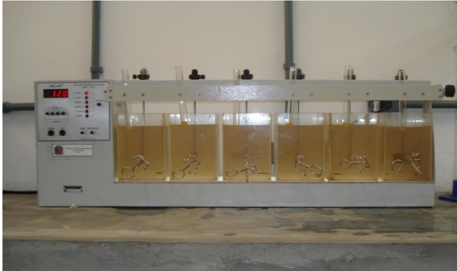
Figura 5.1 Jar-Test com a turbidez de 200uT.
