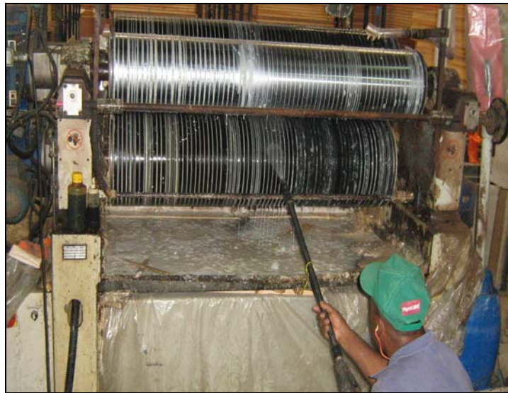
Figura 4.3. Limpeza da coladeira com máquina de alta pressão Fonte: Acervo pessoal, imagem obtida em 29 de junho de 2010
