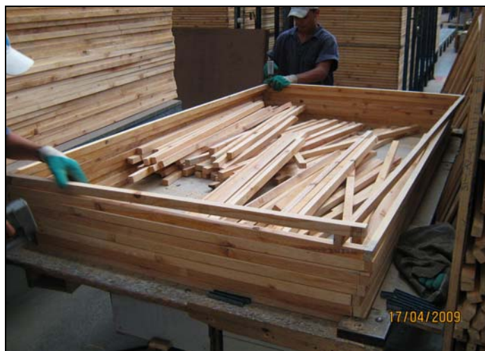
Figura 3.9. Etapa de montagem dos quadros (confeccionados com requadros de madeira de pinus) utilizados na montagem de painéis e portas
