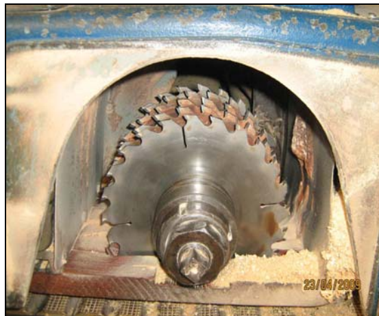
Figura 4.2. Detalhe do conjunto de cinco serras na multilâmina
