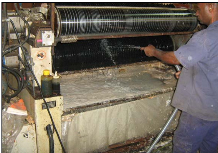
Figura 3.13. Limpeza da coladeira com mangueira (água com pouca pressão)
