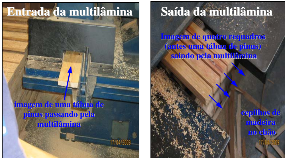
Figura 3.11. Etapa do corte (longitudinal) da tábua de pinus no equipamento multilâmina para a produção de requadros
