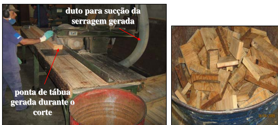
Figura 3.10. Etapa do corte (transversal) da tábua de pinus no equipamento traçador (imagem maior) e detalhe das pontas de tábua geradas em um tambor (imagem menor)
