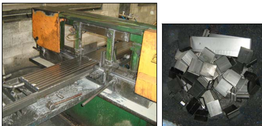
Figura 3.15. Etapa do corte (transversal) dos tubos de aço no equipamento serra de fita (imagem maior) e detalhe das pontas de tubo de aço geradas em um tambor (imagem menor) Fonte: Acervo pessoal, imagem obtida em 08 de maio de 2010 (imagem maior) e em 08 de maio de 2010 (imagem menor)
