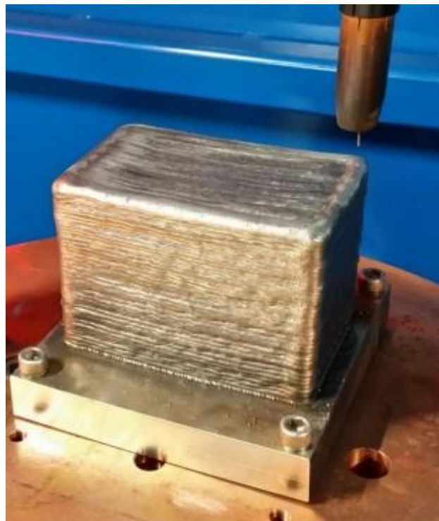
Figura 3.31 - Parede retangular fabricada por MA feita com um fio de arame de aço inoxidável do tipo ABNT 308L,
