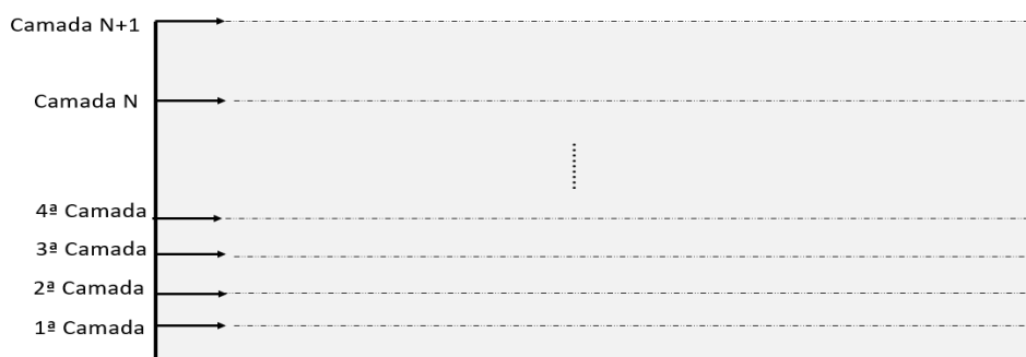
Figura 4.2- Método para deposição de camadas utilizado para fabricação das paredes: Camadas unidirecionais- a deposição é feita sempre na mesma direção
