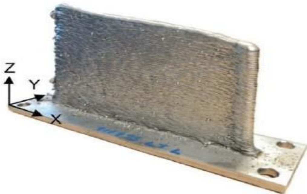
Figura 3.26 - Construção de uma parede de um aço ABNT 316LSi e sistema de coordenadas usado empregando-se a técnica de Manufatura Aditiva.
