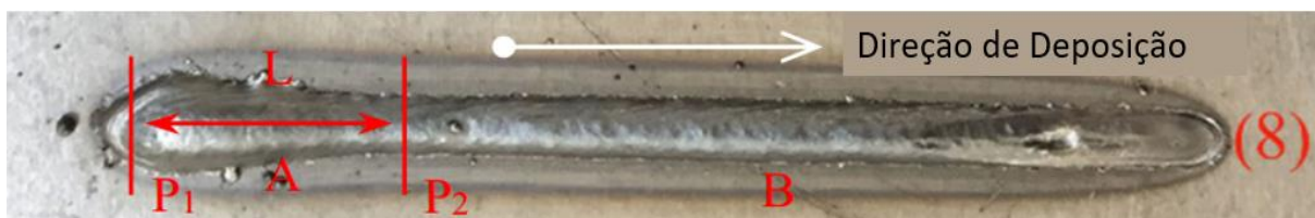
Figura 3.20 - Deformação encontrada no início e no fim da deposição de um cordão de solda obtido a partir dos parâmetros listados em 8 na Figura 3.21. P1 representa o ponto de ignição do arco (quando a tocha ainda estava na região A). Quando a tocha atingiu P2, a poça de fusão atingiu um regime quase estacionário que se estendeu até o final da região B.
