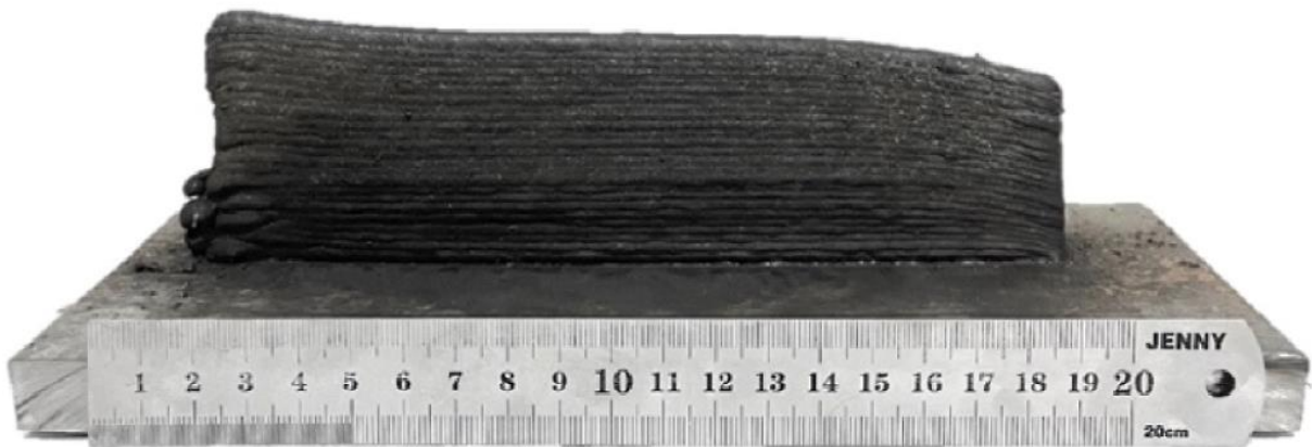
Figura 3.35 - Parede fabricada com aço ABNT 316L usando o processo WAAM com GMAW. Fonte: Adaptada de Jafarзад-Shayan et al. (2023).
