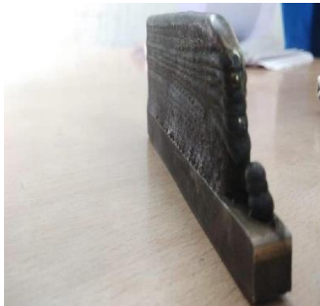
Figura 3.9 - Amostra de uma figura após fabricação usando Manufatura Aditiva a arco elétrico. Fonte: Sharma (2019).
