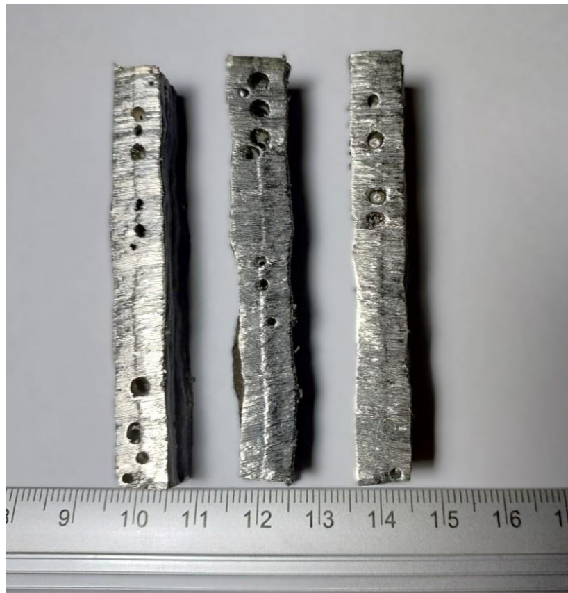
Figura 5.18 - Poros identificados em cortes das paredes fabricadas pela condição III – Unidirecional com resfriamento – sentido longitudinal na região da base. Os poros estão associados com a dificuldade do controle do nível de água nas fabricações com resfriamento ativo.
