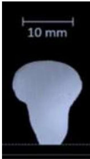
Figura 3.5 - Peça em colapso estrutural após fabricação por Manufatura Aditiva WAAM.
