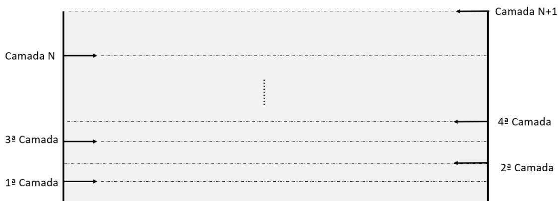
Figura 4.3 - Método para deposição de camadas utilizado para fabricação das paredes: Camadas bidirecionais- a deposição é feita em direções alternadas.
