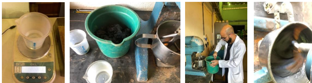
Figura 20: Reprodução em laboratório do pastefill composto por rejeito cimentado.
