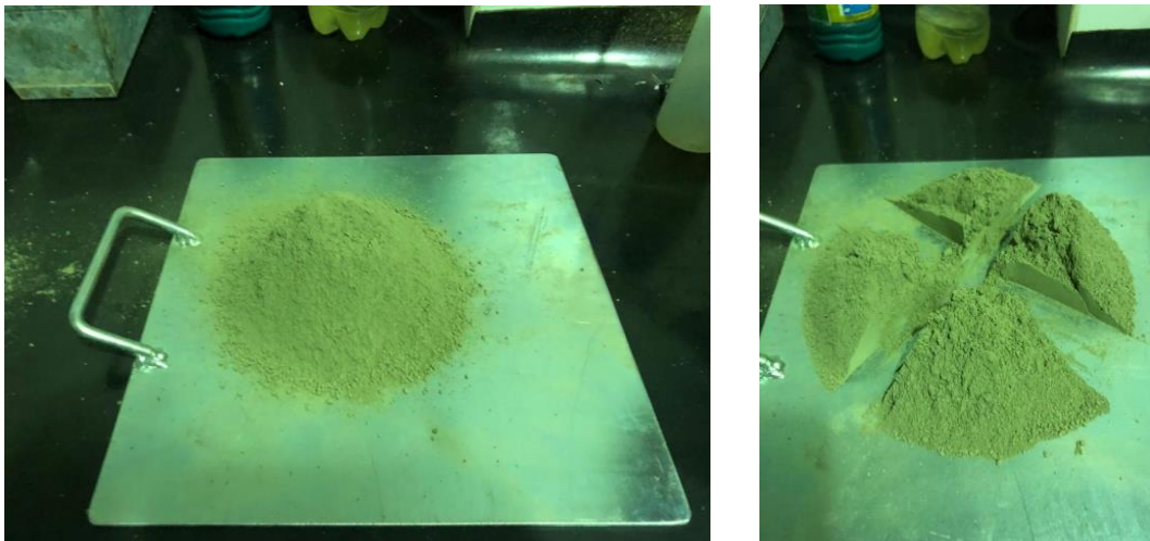
Figura 16: Quarteamento do rejeito para análises químicas.
