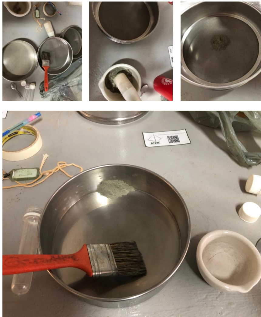
Figura 17: Preparação da amostra de rejeito para ensaio de difração e fluorescência de raios X.
