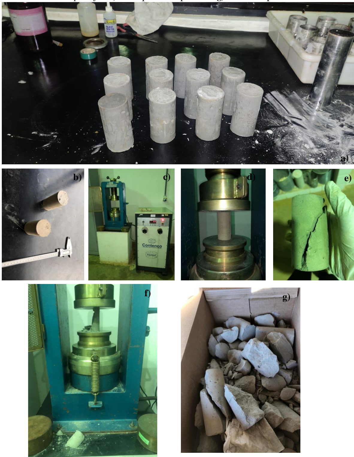
Figura 25: a) Corpos de Prova 5x10 cm para análise. b) Mensuração das dimensões dos C.P.'s. c) Prensa utilizada para ensaios. d) C.P. antes do rompimento. e) Ensaio de compressão uniaxial do pastefill . f) C.P. após o rompimento. g) C.P.'s rompidos.
