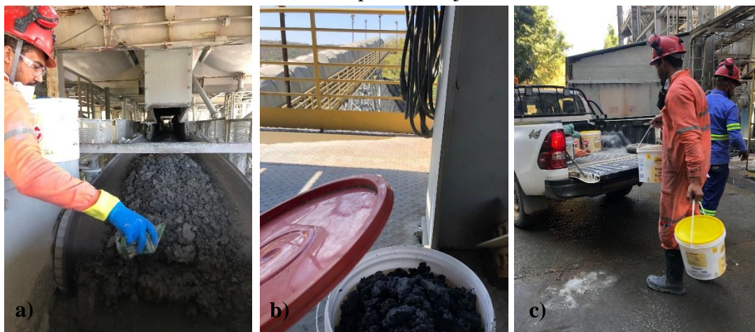
Figura 14: a) Coleta in-situ do rejeito. b) Acondicionamento do rejeito. c) Transporte do rejeito.
