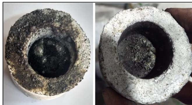
Figura B.1 - Cadinhos de alta alumina com projeção metal/escória nas bordas, sendo que em um deles ocorreu projeção.
