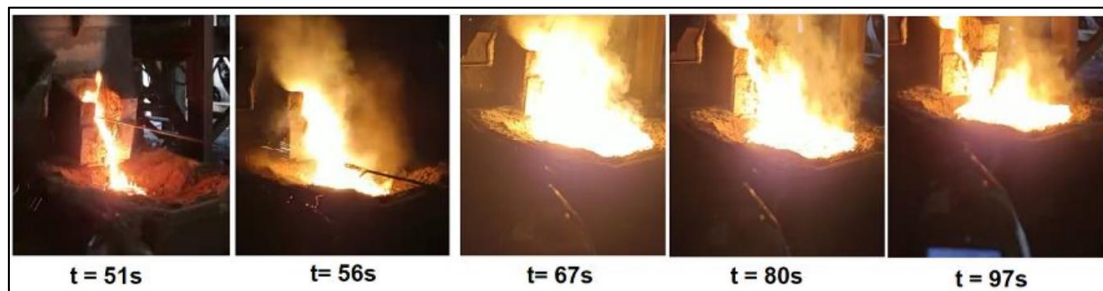
Figura 5.37 –Vazamento de metal/escória em uma corrida do teste EAF2.
