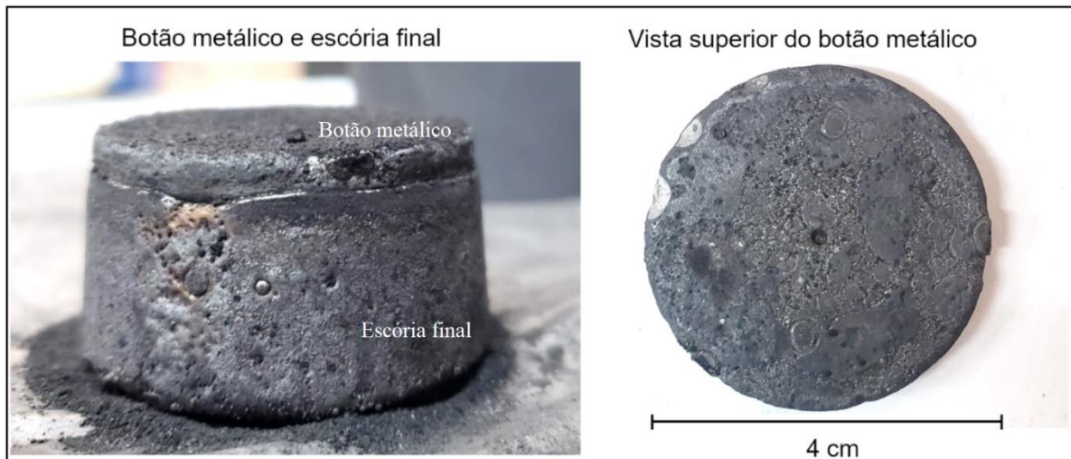
Figura 5.12 - Botão metálico e escória final obtidas no teste 1.
