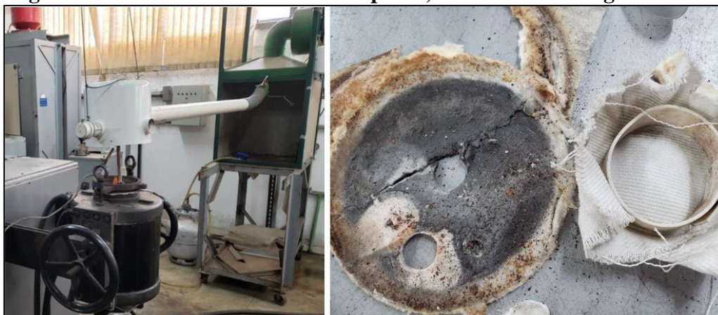
Figura 5.19 - Sistema de exaustão adaptado, lã de vidro e manga utilizada.
