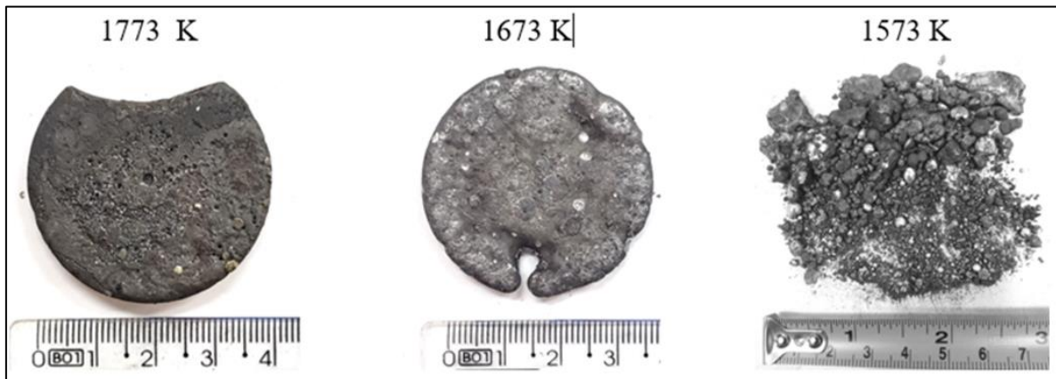
Figura 5.14 – Frações metálicas obtidas nos testes 2, 3 e 4A, com temperaturas variando entre 1773-1573 K e no qual foi utilizado calcário como fluidificante.
