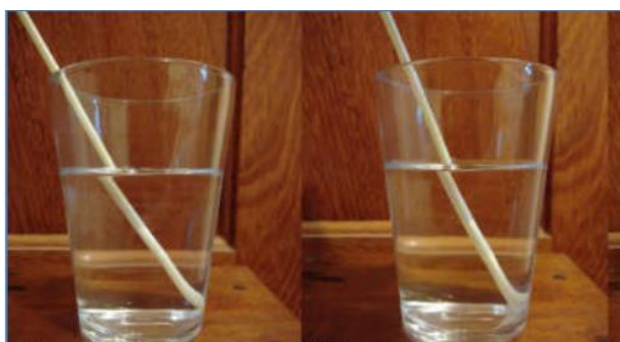
Figura 10: Exemplo do conceito da Refração da Luz ao se demonstrar um canudo, em posições diferentes, em um copo com água.
