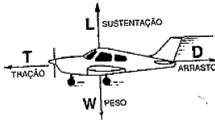
Figura 12: Componentes das forças atuantes em um avião em um voo horizontal.
