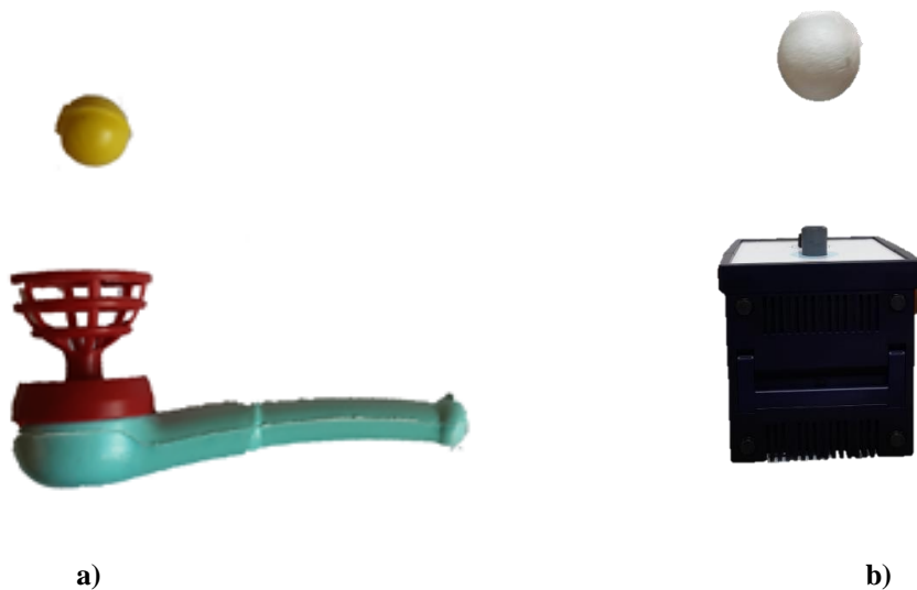
Figura 18: Aparatos experimentais sugerido na intervenção 2 da SEI. a) Soprador de plástico, b) Soprador de ar Phywe modelo 13770-94.
