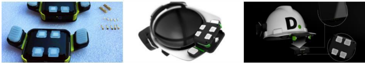
Figura 7 - Capacete Smart Helmet Clip e detalhes dos seus sensores.
