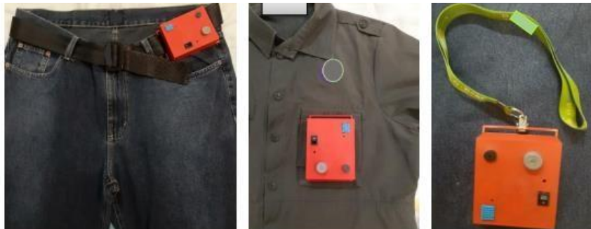
Figura 16 - Dispositivo vestível de medição de qualidade do ar em minas subterrâneas.
