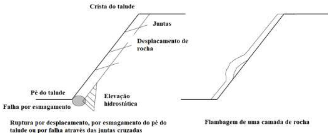
Figura 8 - Exemplos de rupturas por deslocamento e flambagem
