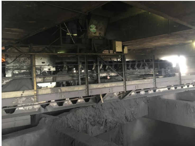
Figura 3.10: Distribuidor rotativo (Gerdau- Usina Ouro Branco-MG)
