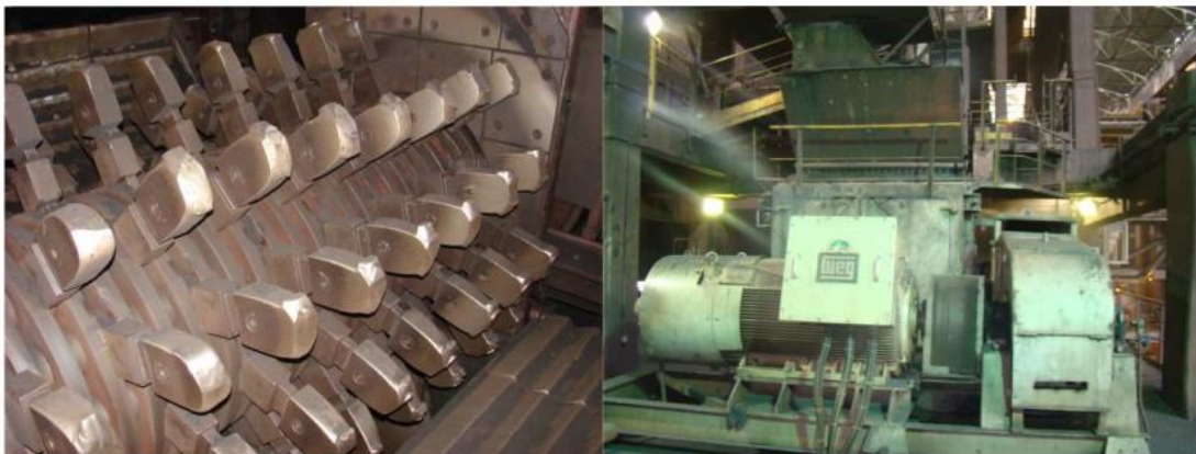
Figura 3.7: Britador de martelos (Gerdau- Usina Ouro Branco-MG)
