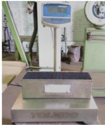
Figura 4.4: Ensaio de densidade da mistura de carvão
