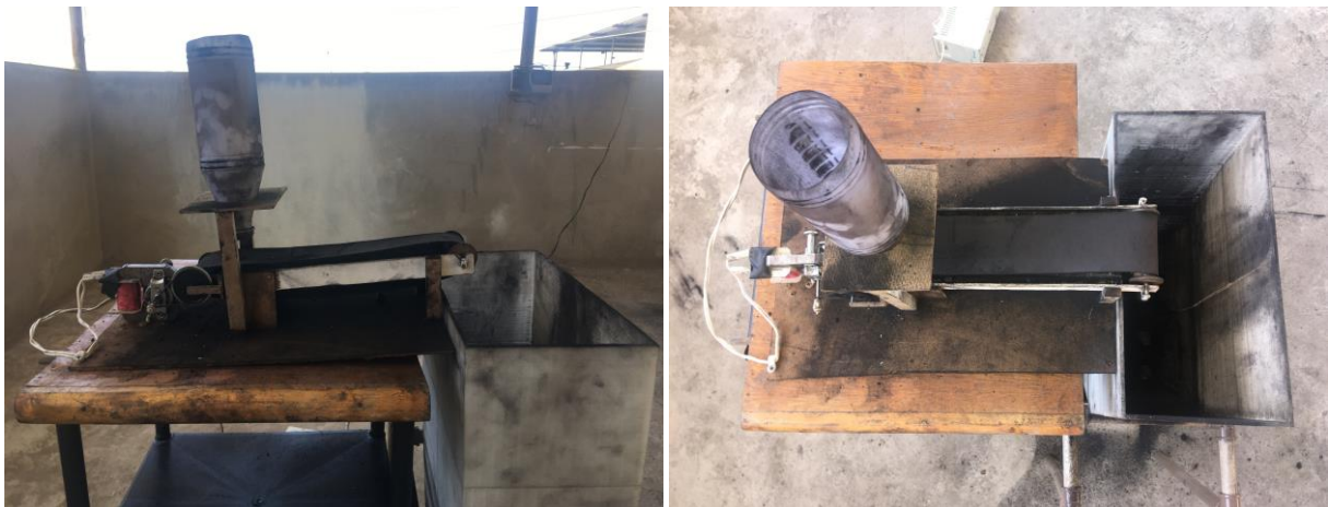
Figura 4.8: Sistema de carregamento, mini correia transportadora
