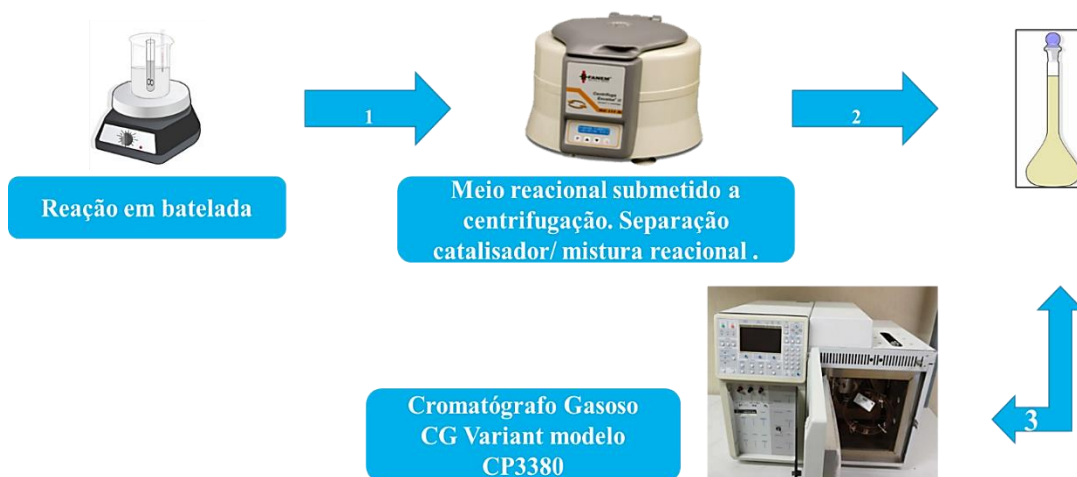
Figura 10 - Esquemática ilustrativa das etapas dos ensaios catalíticos e análise da conversão/seletividade.
