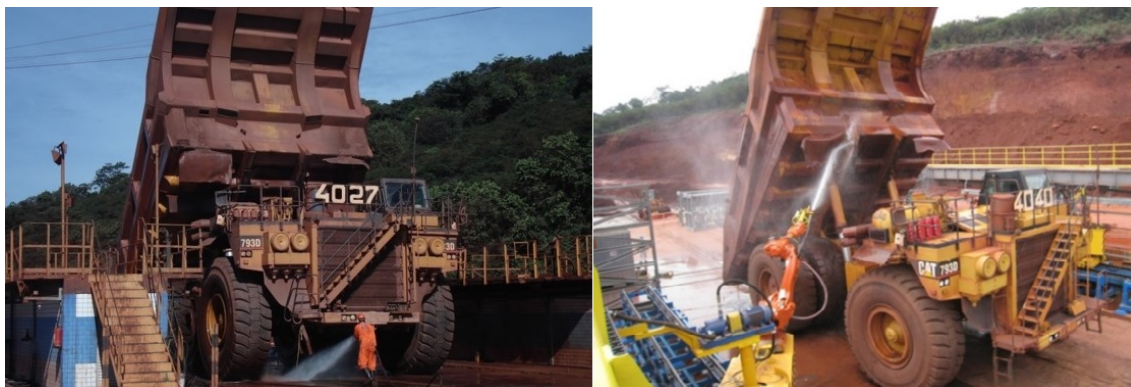
Figura 5.5: Lavagem manual e robotizada de equipamentos de grande porte.
