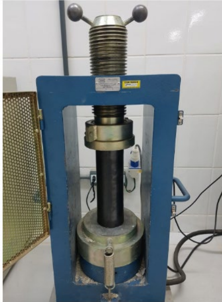
Figura 3 – Ensaio compressão corpo de prova grupo TUBO
