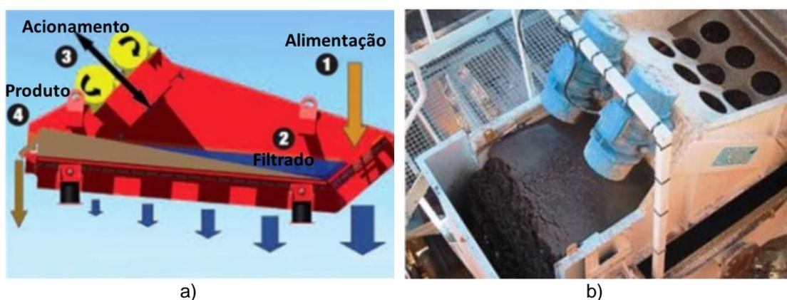
**Figura 3. 15 - a) Representação esquemática de uma peneira desaguadora. (Fonte: McLanahan, 2018). b) foto de uma peneira desaguadora industrial. (Fonte: Eral, 2012)**
