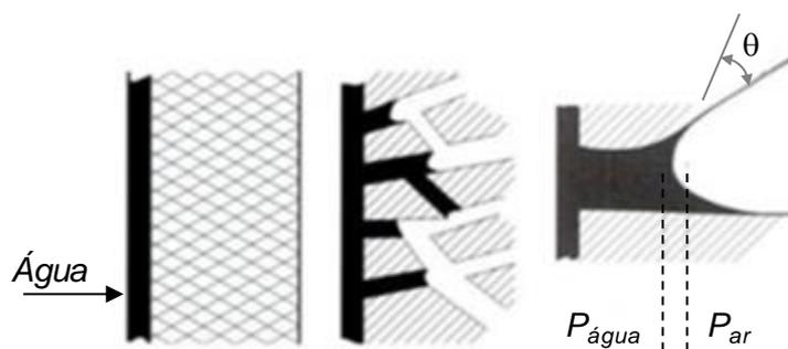
Figura 3. 19 - Fenômeno da capilaridade. (FREITAS *et al.*, 2002).
