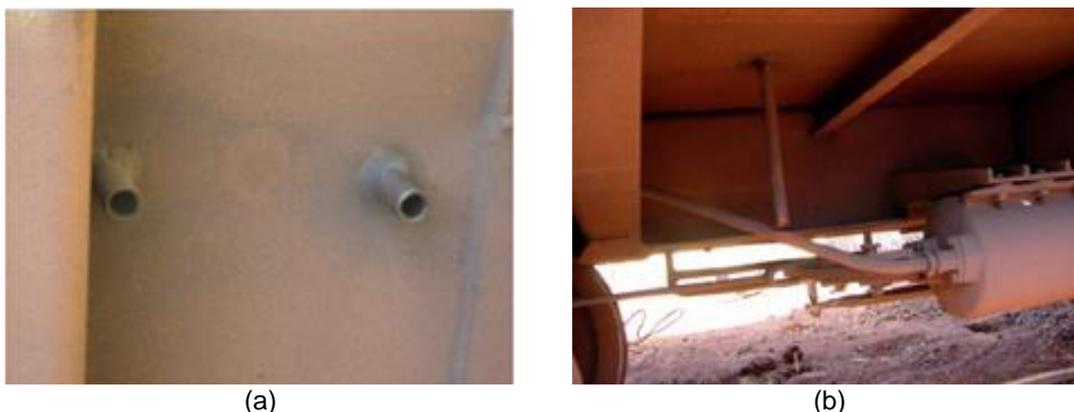
Figura 3. 16 - a) Furos na lateral dos vagões; b) Furos na parte inferior dos vagões. (FERREIRA, 2009).
