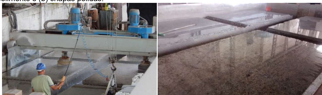
FIGURA 2.6 – Acabamento das chapas de rochas ornamentais: (a) equipamento de levigamento e polimento e (b) chapas polidas.
