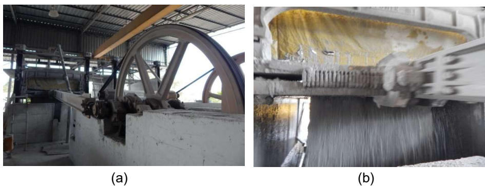
FIGURA 2.3 – Tear tradicional (a) estrutura do tear e (b) detalhe do bloco de granito durante corte.
