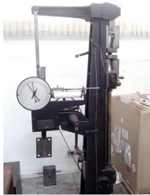
Figura 4.11: Máquina Amsler Frères do Laboratório de Ensaios Mecânicos do Departamento de Engenharia Metalúrgica da UFOP.
