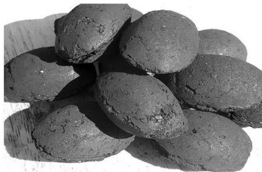
Figura 3.19: Briquetes de carvão mineral no formato ovoide (BOROWSKI e HYNAR, 2013).
