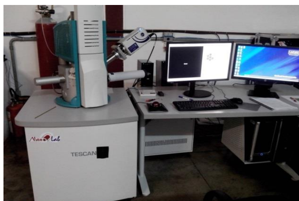
Figura 4.10: Microscópio Eletrônico de Varredura do laboratório NANOLAB do Departamento de Engenharia Metalúrgica da UFOP.
