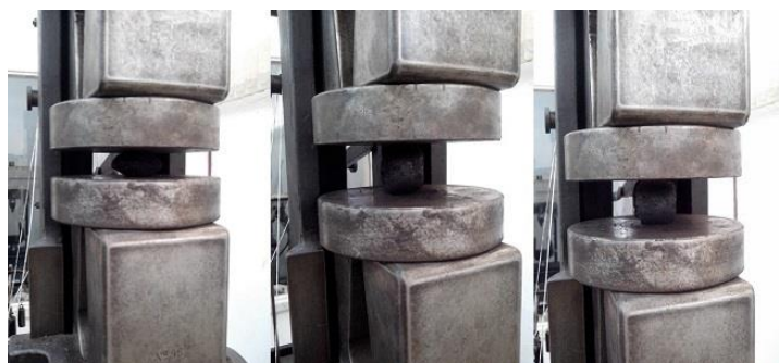
Figura 4.12: Ensaio de compressão axial nas três diferentes dimensões do briquete.
