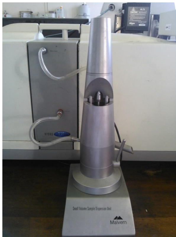
Figura 4.16: Destaque para a célula de análise de amostras em sistemas aquosos. (Institute of Particle Science and Engineering, Leeds University, 2014).
