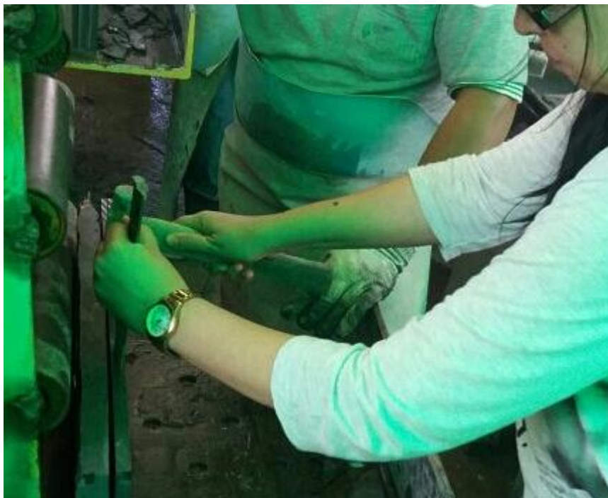
Figura 3.2: Abertura da rocha com talhadeira. (Próprio autor, 2016).
