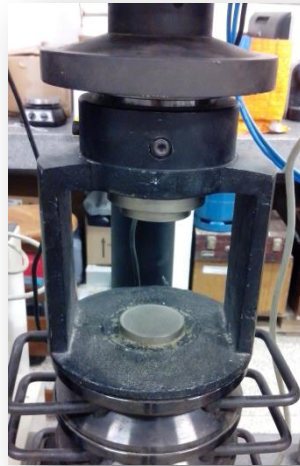
Figura 3.5: Dispositivo de compressão para CPs 5x10cm
