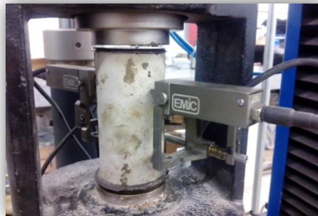
Figura 3.6. Determinação do módulo de elasticidade estático
