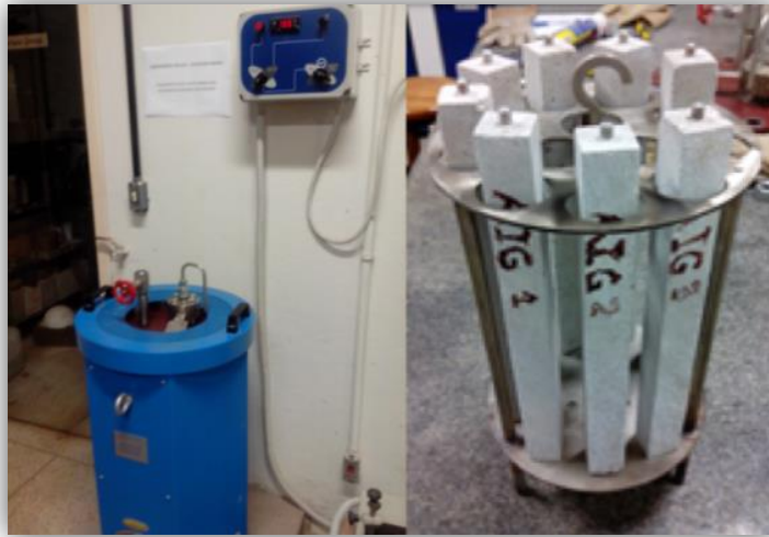
Figura 3.8: Autoclave e as barras no suporte
