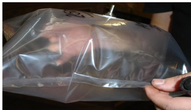
**Figura 4.7:** Bolsa de Tedlar para armazenagem dos gases não condensáveis.
