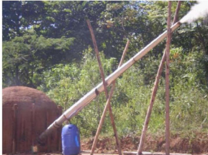
Figura 3.22: Recipiente instalado no Forno Rabo Quente para coleta de alcatrão<sup>[74]</sup>.
