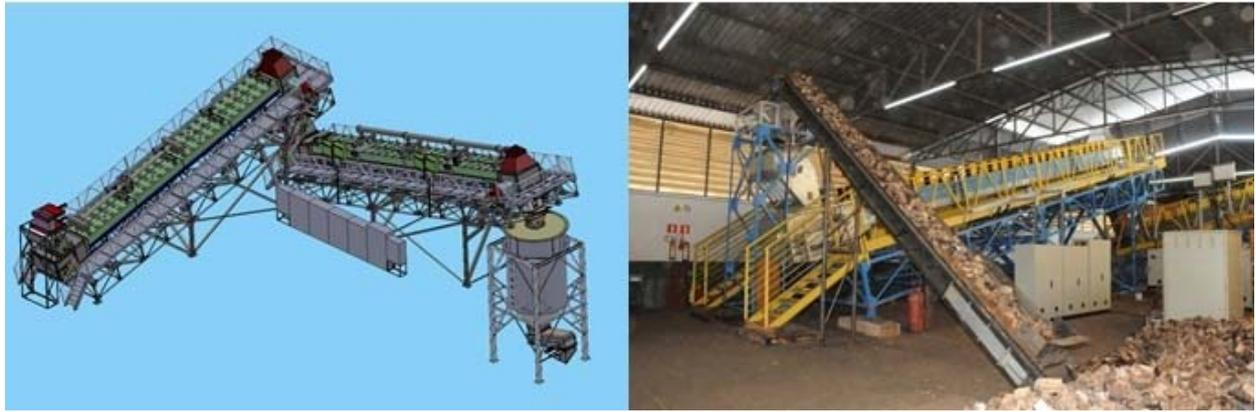
**Figura 4.1: Sistema de carbonização por micro-ondas.**
