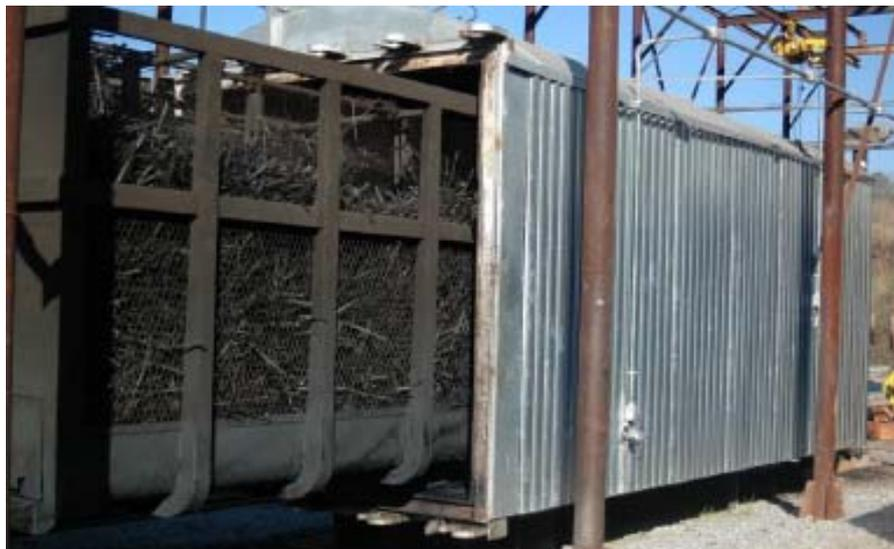
**Figura 3.16:** Carvão produzido sendo retirado do Reator DPC<sup>[39]</sup>.
