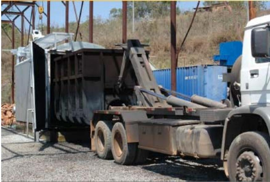
**Figura 3.15:** Caminhão tipo “roll on roll off” colocando container em um reator DPC<sup>[39]</sup>.
