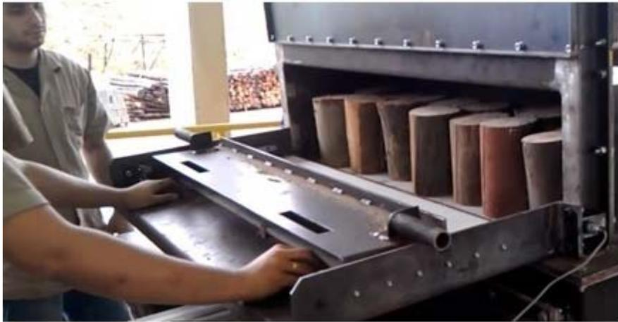
**Figura 4.3: Alimentação dos toletes na UPEC-250 em temperatura ambiente.**
