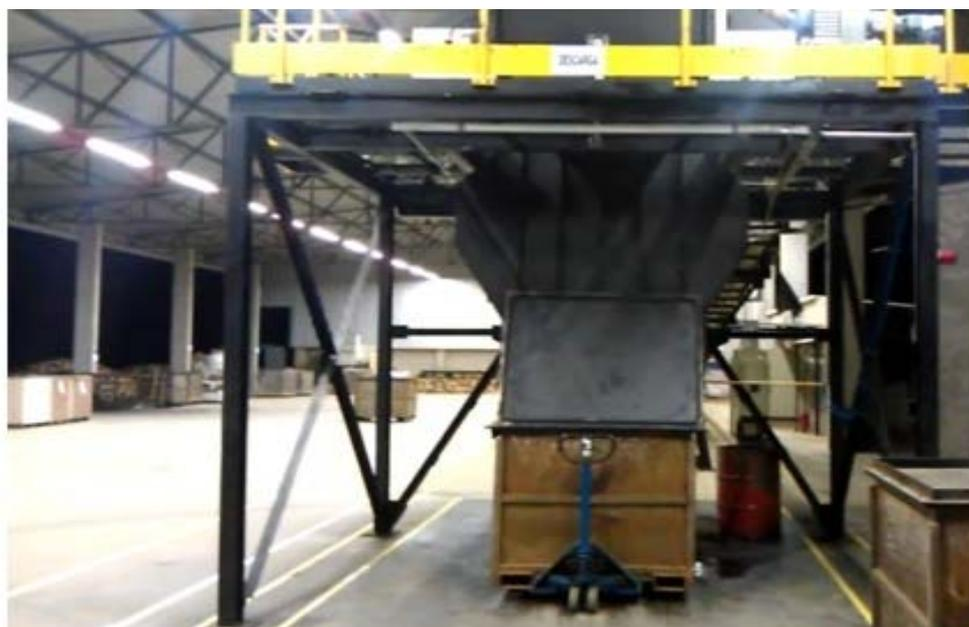
**Figura 4.5: Descarga do carvão em caixas para resfriamento.**
