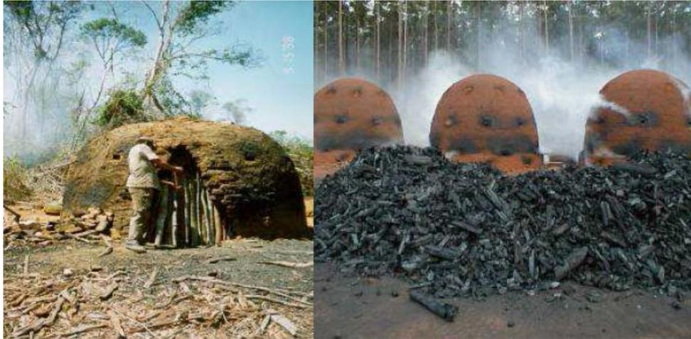
Figura 3.9: Fornos tipo “Rabo Quente” de superfície<sup>[31]</sup>.
