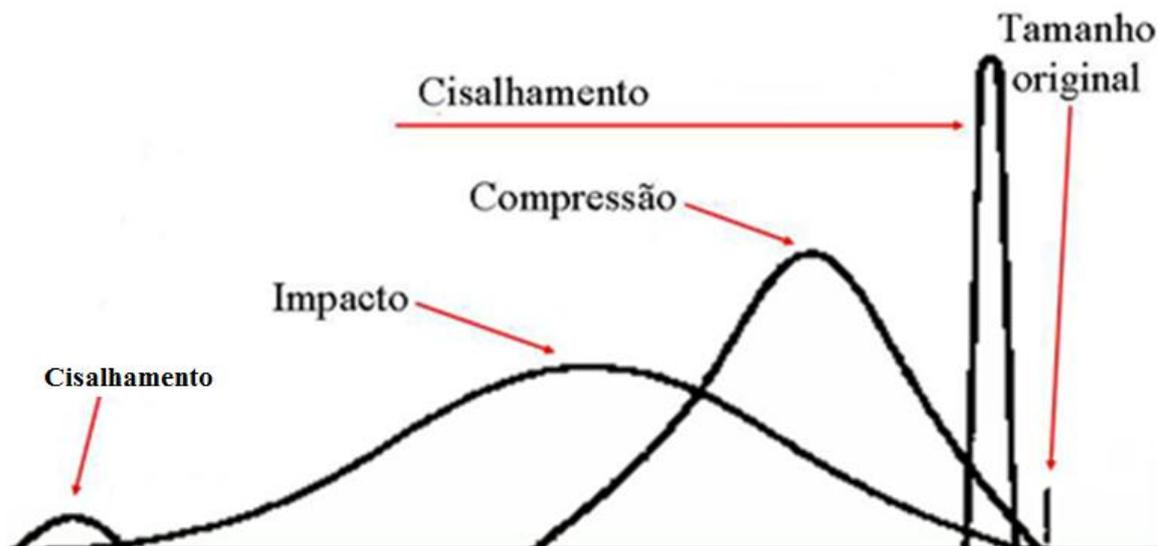
**Figura 5.10 – Relação esquemática entre o regime de movimentação de um moinho e a granulometria do produto gerado (cominuído). Adaptado de Luz et al. (2010).**
