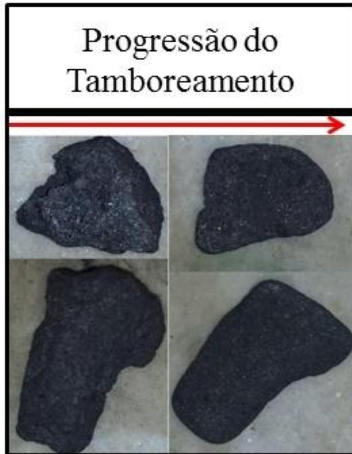
**Figura 5.1 – “Polimento” de duas partículas de coque mediante o tamboreamento a 24 rpm – 4200 revoluções.**
