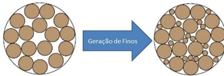
**Figura 3.14 – Preenchimento de vazios devido à geração de finos. Adaptado de Geerdes et al. (2004).**
