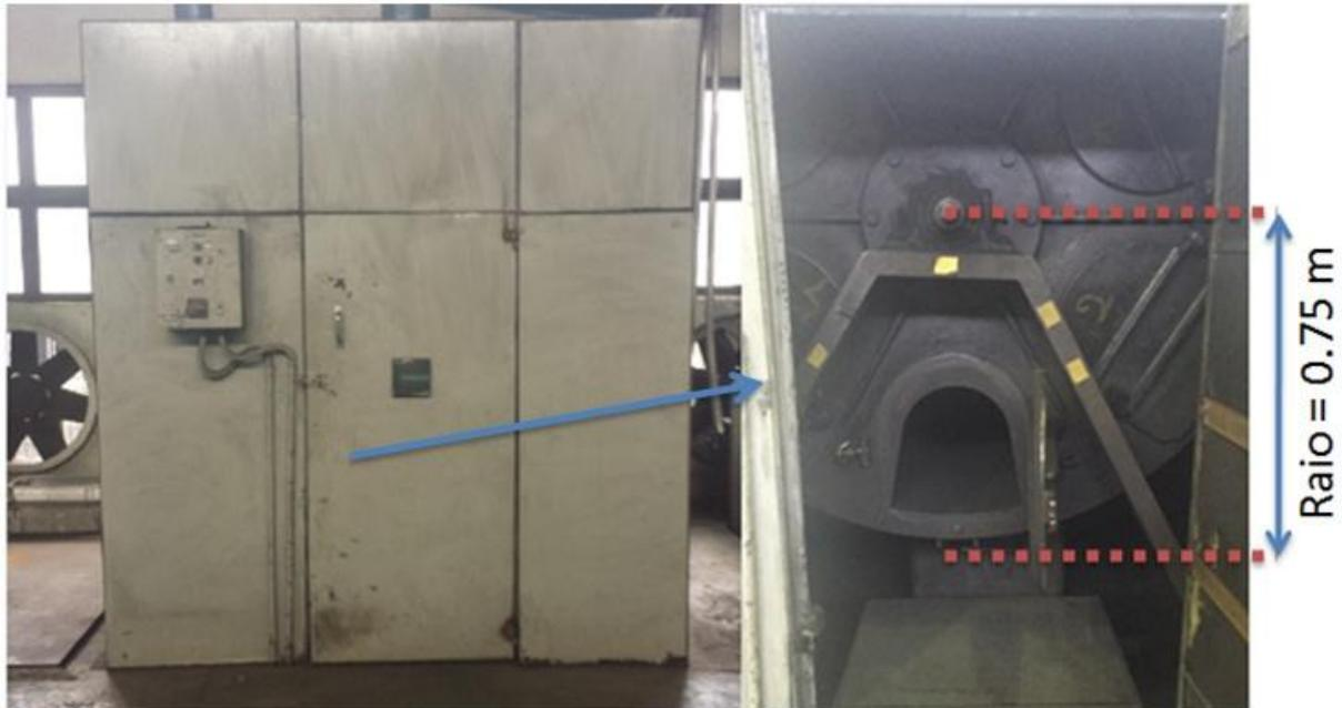
**Figura 4.4 – Tambor Utilizado na Gerdau Aço Minas, segundo a norma JIS K2151.**
