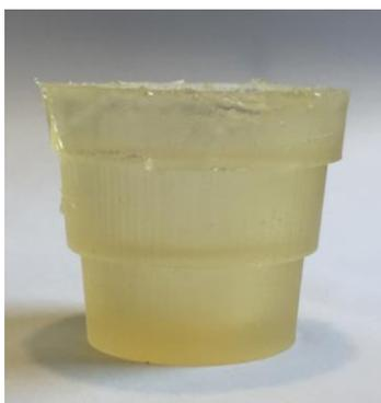
**Figura 53:** Artefato desenvolvido por moldagem por vazamento.
