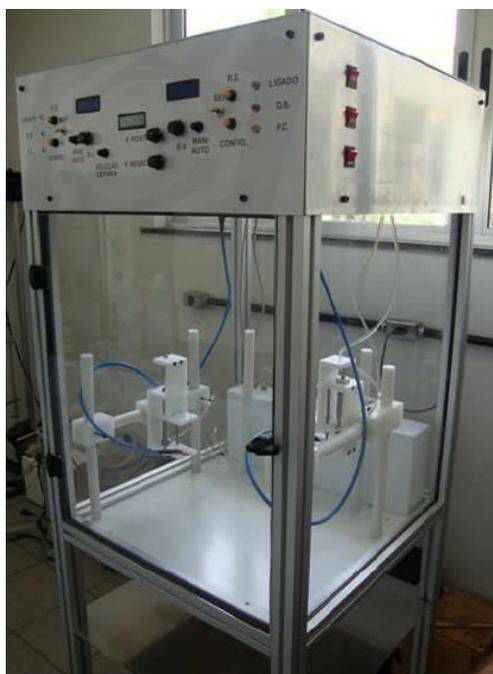
**Figura 24:** Equipamento de eletrofiação com dois acionadores de seringa.
