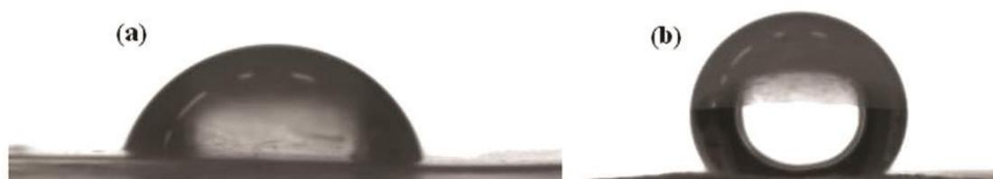
**Figura 40:** Formato da gota de água no lado do ar: (a) Filme de PHB ( $\theta=77^\circ$ ); (b) Nanofibras de PHB ( $\theta=130^\circ$ ).
