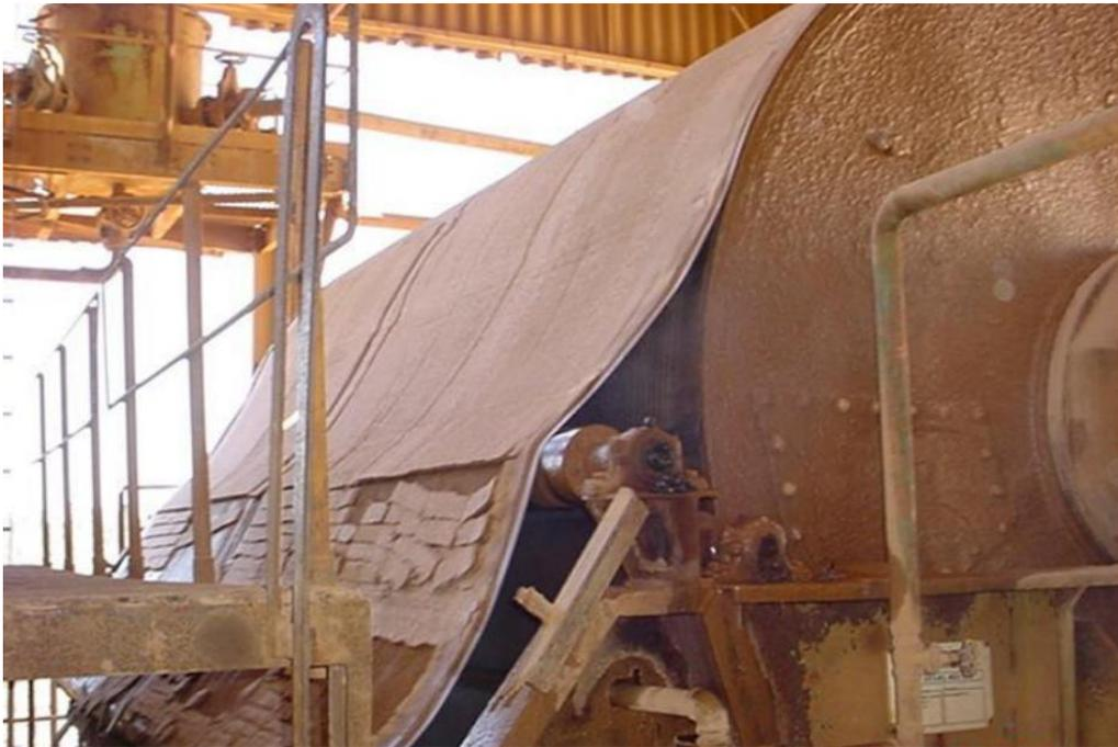
Figura 2.18 – Exemplo de filtro tambor rotativo (Araxá – MG)
