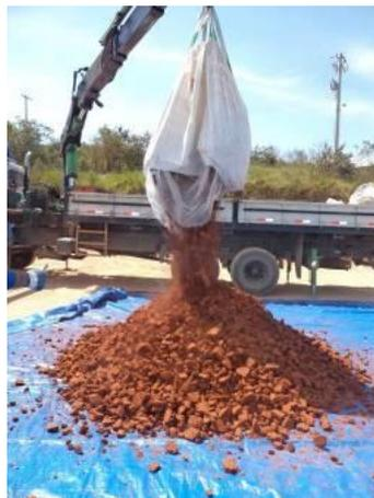
Figura 3.6 – Simulação da formação da pilha teste de resíduo filtrado da CBA (Nery, 2013)
