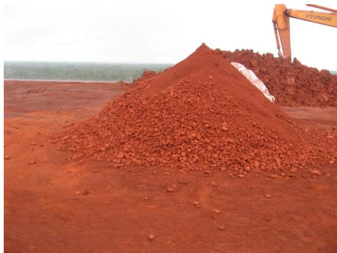
Figura 4.6 – Conformação final da pilha de resíduo disposta em seu ângulo de repouso
