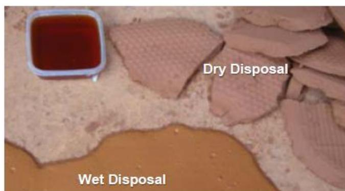
Figura 3.5 – Comparação entre os resíduos de disposição úmida e seca (Fonte: CBA, 2013)
