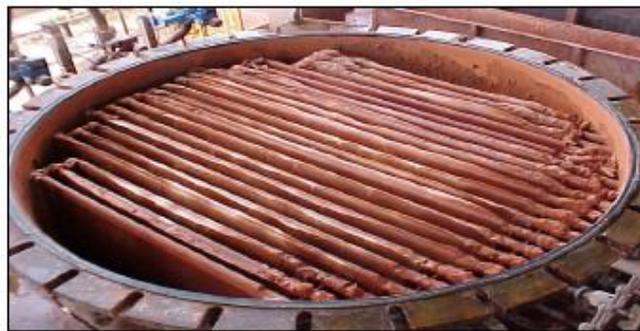
Figura 2.6 – Filtros para separação da lama vermelha (Fonte: Souza, 2010)
