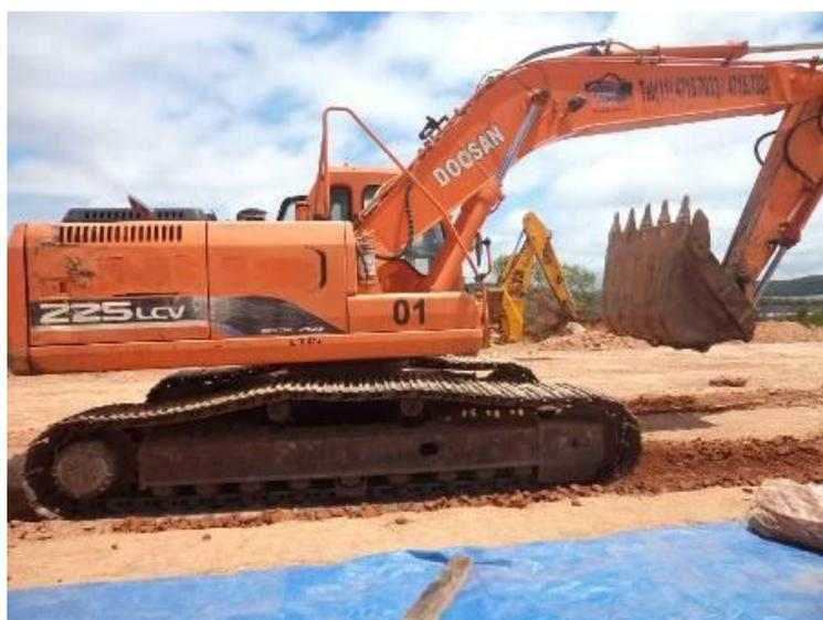
Figura 3.7 – Compactação do resíduo nas valas com a escavadeira de esteira Doosan SOLAR255LC-V (Nery *et. al.*, 2013)
