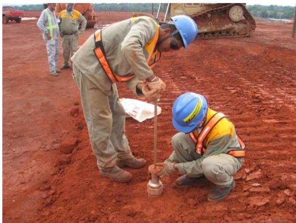
Figura 4.11 – Ensaio para determinação da densidade “in situ” (*hif*)
