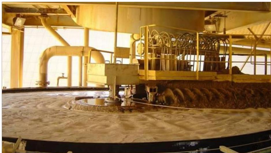
Figura 2.23 - Filtro horizontal de mesa (Araxá – MG)
