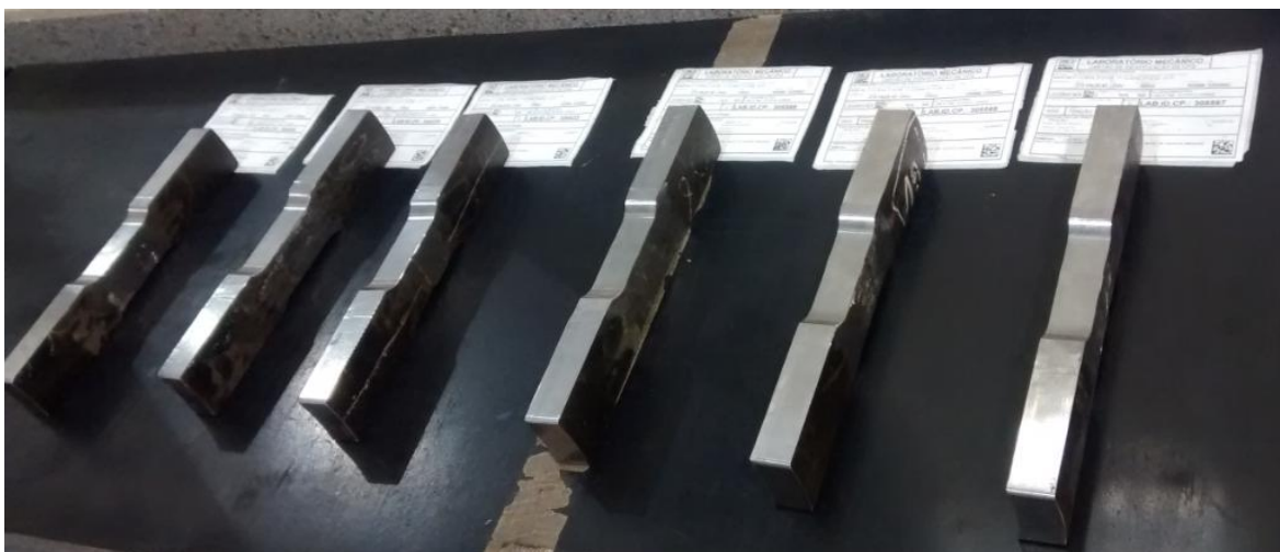
Figura 4.11- Fotografia dos corpos de prova full size confeccionados para ensaio de tração.
