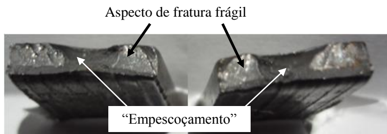
Figura 5.21- Macrofotografia do corpo de prova ensaiado em tração correspondente à 8ª camada da junta JM.
