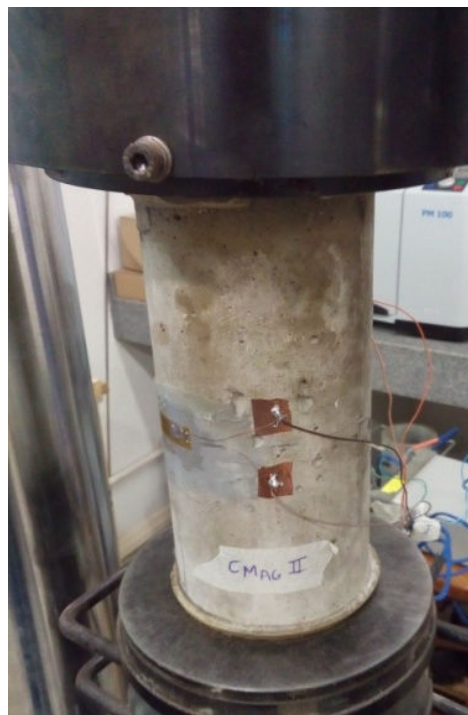
Figura 5.4 - Ensaio de módulo de elasticidade estático.
