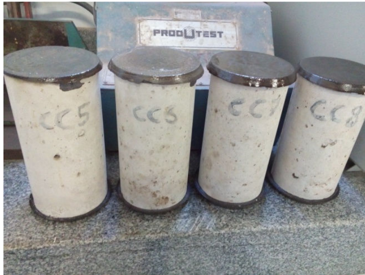
Figura 5.2 - Corpos de prova capeados com enxofre.
