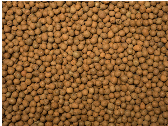
Figura 3.3 – Aspecto da argila expandida brasileira (Tipo 2215) produzida pela empresa Cinexpan (CINEXPAN, 2016).
